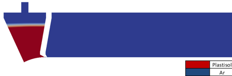
Figura 59- Geometria ilustrativa do processo de recobrimento utilizada nos estudos computacionais.
