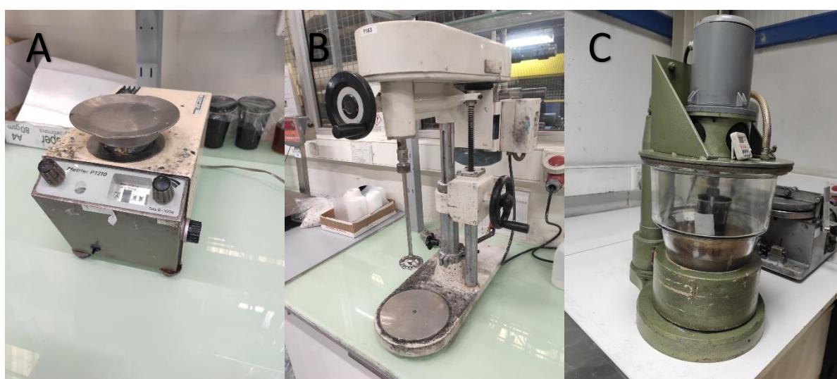
Figura 40- Equipamentos utilizados para a produção dos plastissóis de PVC utilizados no estudo: A) Balança; B) Misturador; C) Equipamento de vácuo.
