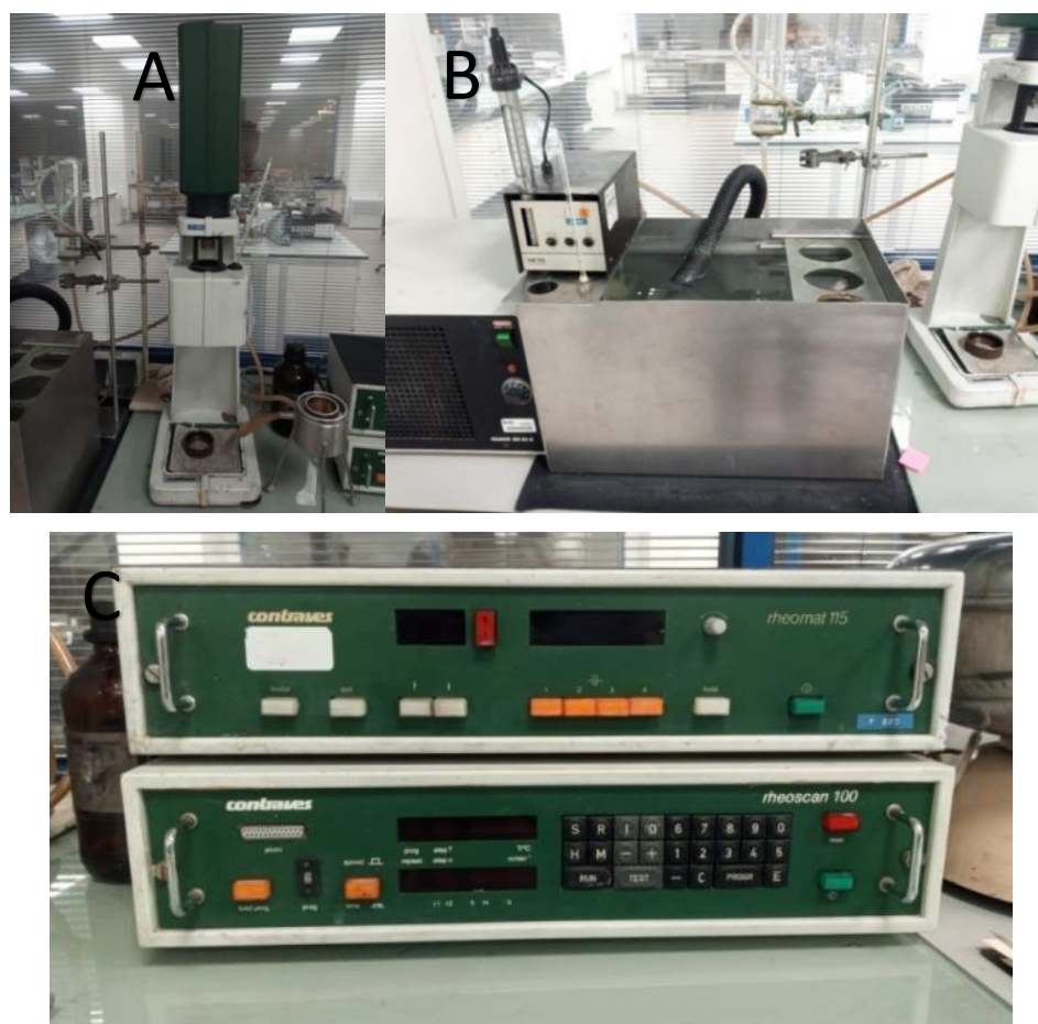
Figura 42- Instrumento de controlo do reómetro de cilindros concêntricos: A) Reómetro de cilindros concêntricos; B) Sistema de controlo de temperatura; C) Sistema de controlo do ensaio.
