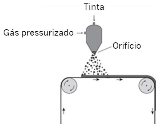
Figura 16- Ilustração do processo de recobrimento por spray. Imagem adaptada de [21].
