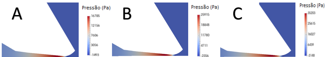
Figura 152- Influência da velocidade de processo no valor de pressão à passagem pela faca: A) 15 m/min; B) 25 m/min; C) 35 m/min.
