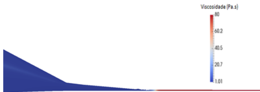
Figura 150- Perfil de viscosidade logo após a passagem pela faca para o plastisol 2 com tempo de armazenamento de 0 horas e uma temperatura de 25°C.
