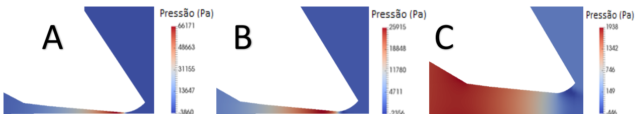
Figura 158- Influência de diferentes dosagens de plastisol aplicado na pressão à passagem pela faca: A) 120 g/m²; B) 250 g/m²; C) 750 g/m².
