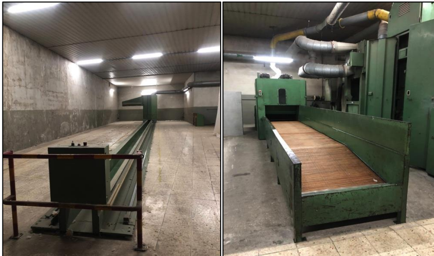
Figura 12 – Abridor (esquerda) e passadeira do batedor (direita)
