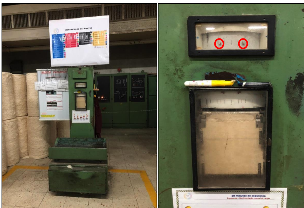
Figura 32 - Balança para pesagem das mantas no batedor
