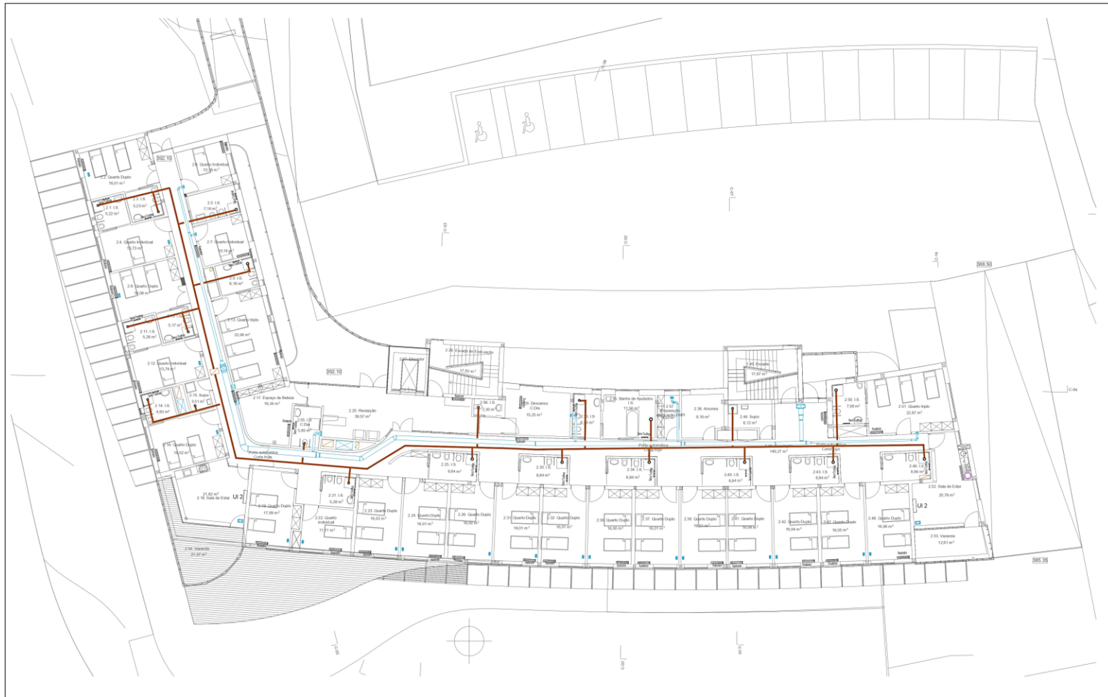
Figura 50 - Projeto de AVAC previsto para o piso 1
