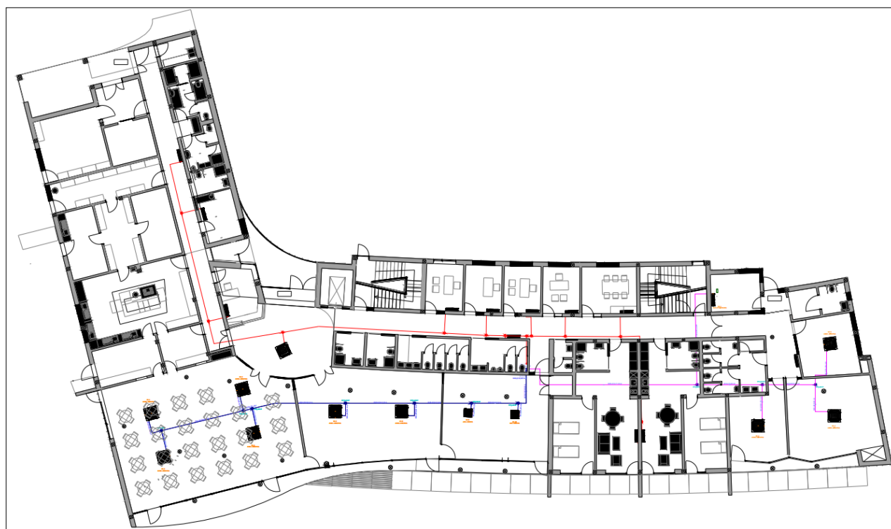
Figura 72 - Sistemas VRF 1,2 e 3 presentes no piso 0
