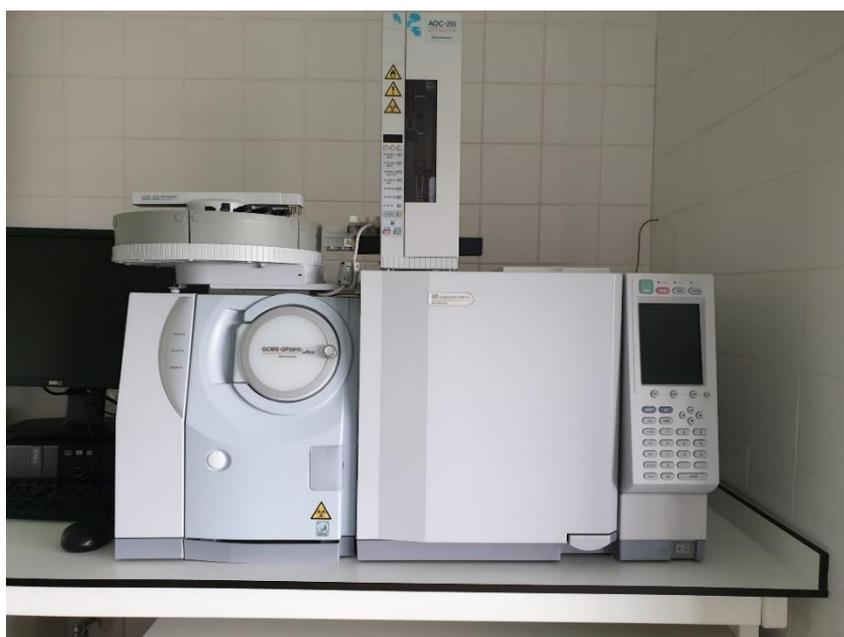
Figura 15 – Equipamento de cromatografia gasosa acoplada a espectrometria de massa. Modelo GC890-MS5973N, coluna apolar TRB-WAX (Comprimento:20m; Espessura: 0,2 $\mu$ m;Diâmetro: 0,1 mm)
