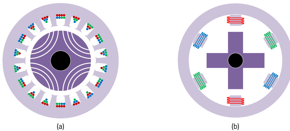
Figura 2.6 – Estrutura de uma máquina de relutância: (a) SynRM; (b) SRM.
