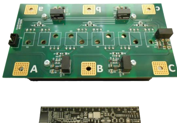
Figura 5.15 – PCB de relés de estado sólido desenvolvida para o sistema integrado proposto.
