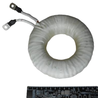
Figura 5.4 – Bobina desenvolvida baseada nos núcleos OE-520026-2 do fabricante Micrometals [1107].
