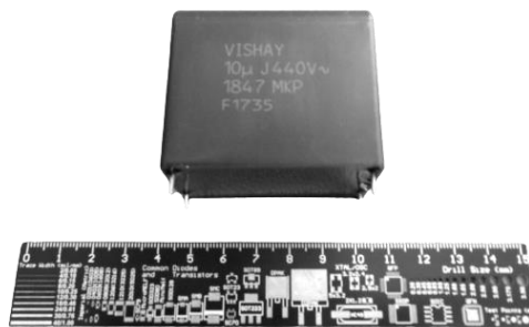
Figura 5.9 – Condensador MKP1847610444Y do fabricante Vishay Roederstein [1108] utilizado no filtro passivo do tipo LCL do sistema proposto.
