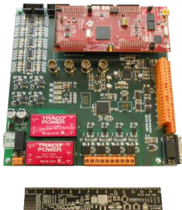
Figura 5.12 – PCB de controlo desenvolvida para o sistema integrado proposto.
