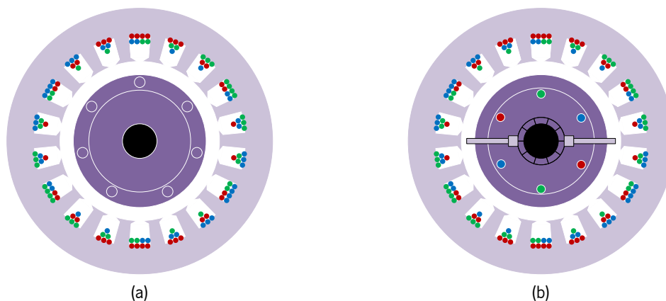
Figura 2.5 – Estrutura de uma máquina de indução: (a) Com rotor em gaiola de esquilo; (b) Com rotor bobinado/duplamente alimentado.
