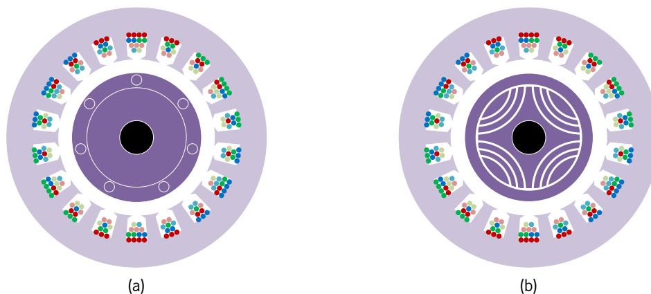
Figura 2.9 – Estrutura de uma máquina brushless duplamente alimentada: (a) Indução; (b) Relutância.
