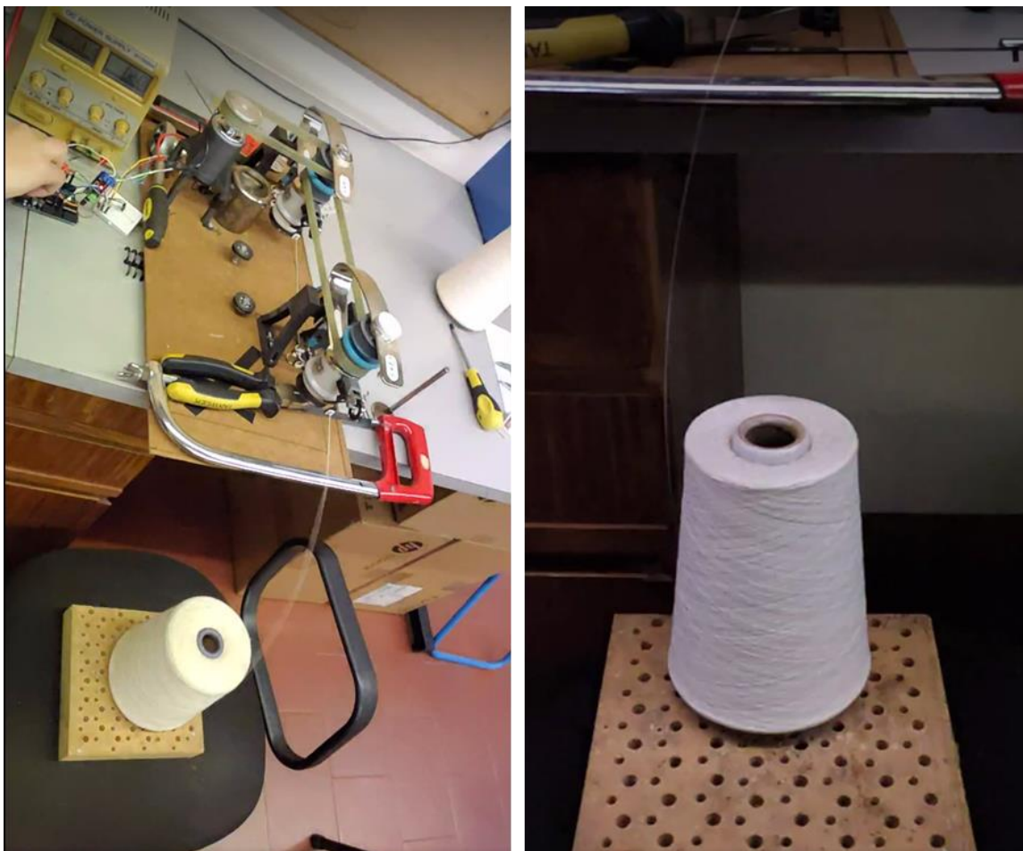
Figura 4.6 - Teste ao desenrolamento pelo topo. Imagem da esquerda corresponde ao testes 1.a. e imagem da direita aos testes 1.b.
