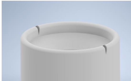
Figura 4.21 - Detalhe na bobine (6) que permite prender o fio
