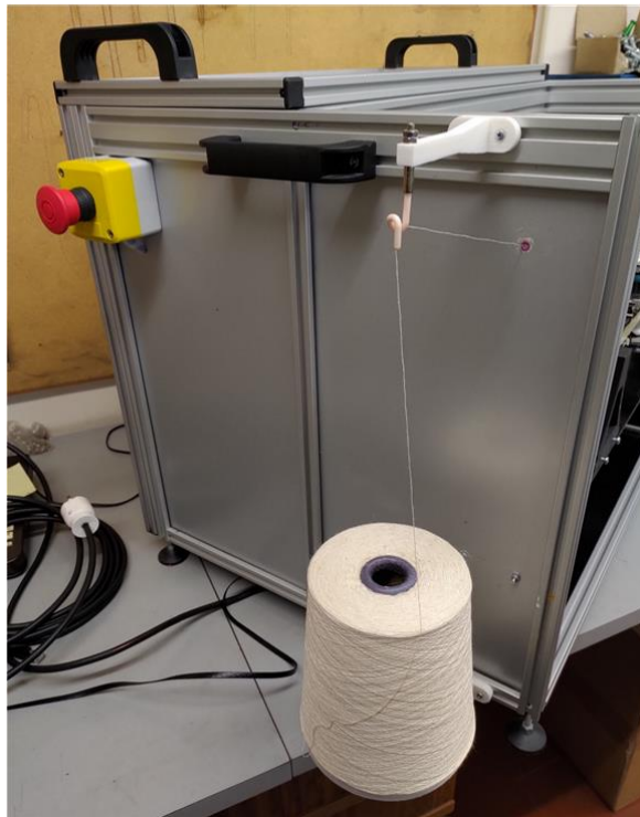
Figura 4.12 - Geometria e montagem do sistema de desenrolamento
