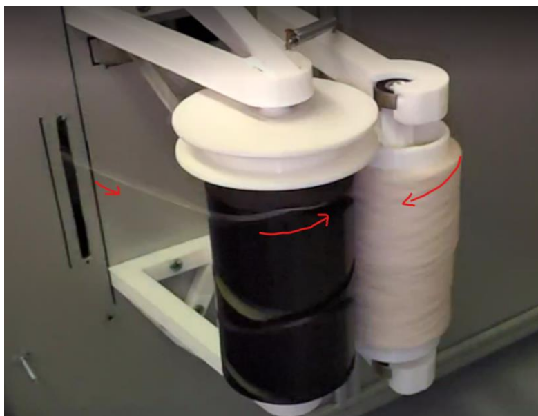
Figura 4.8 - Percurso do fio no sistema de enrolamento
