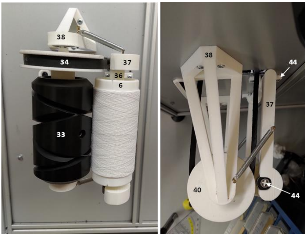
Figura 4.18 - Sistema de enrolamento. À esquerda, vista lateral. À direita vista de topo
