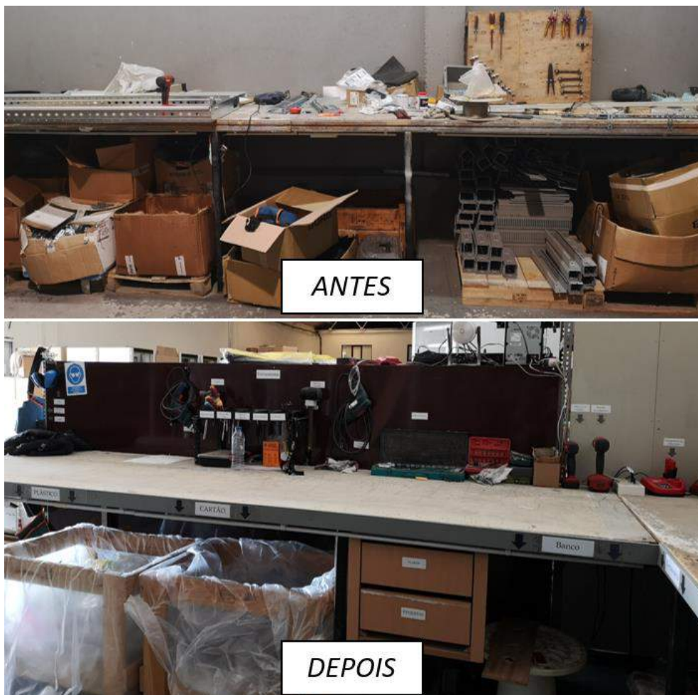
Figura 96 - Zona de serralharia antes e depois dos 5S
