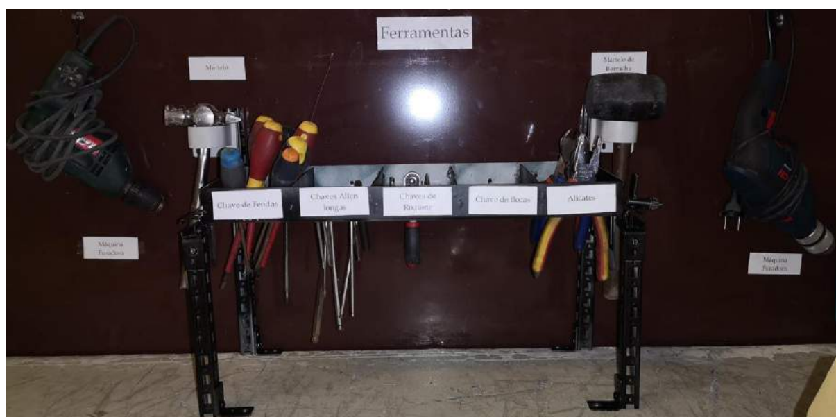
Figura 94 - Organização de ferramentas na zona de serralharia
