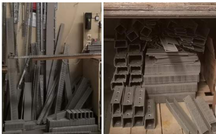
Figura 51 - Desorganização do excedente de calha e tampas plásticas
