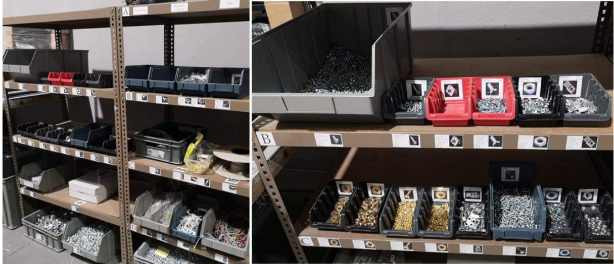
Figura 115 - Supermercado na zona de serralharia
