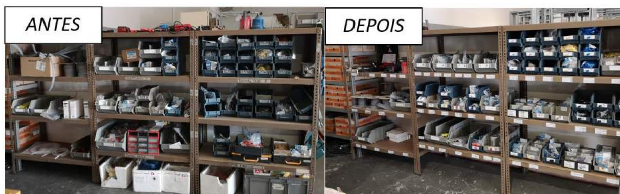
Figura 103 - Estantes na zona de corte de fio antes e depois dos 5S
