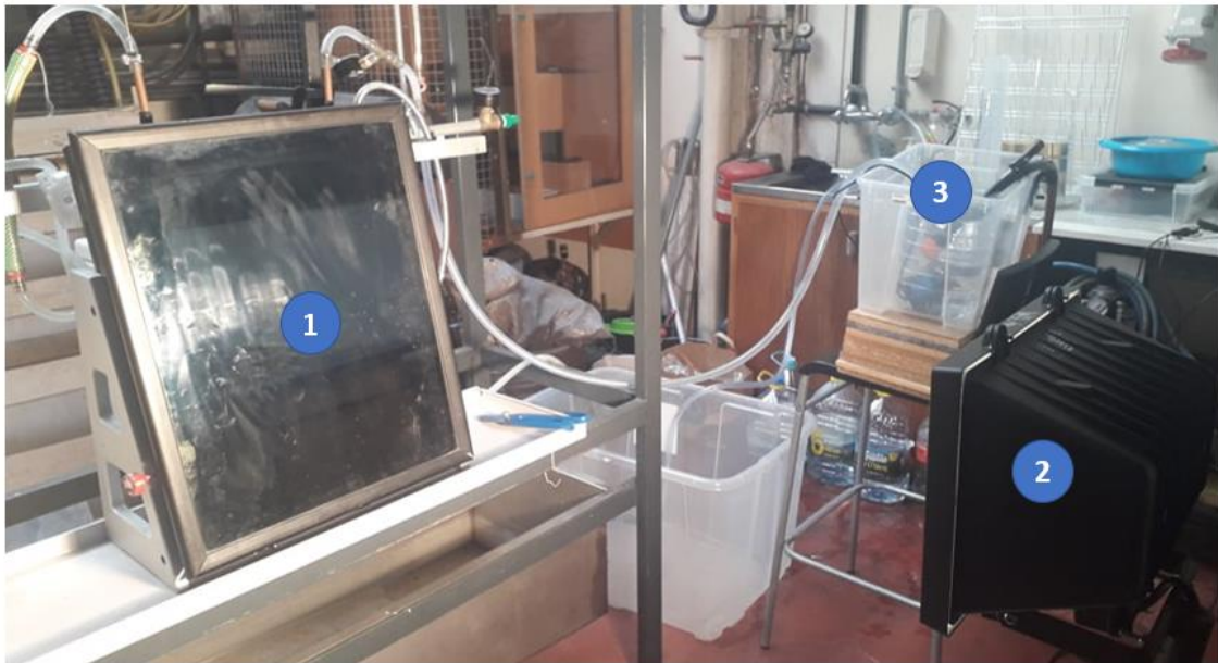
Figura 4.1 - Sistema solar térmico utilizado (1 - Painel solar térmico; 2 - Holofote; 3 – Bomba de água)
