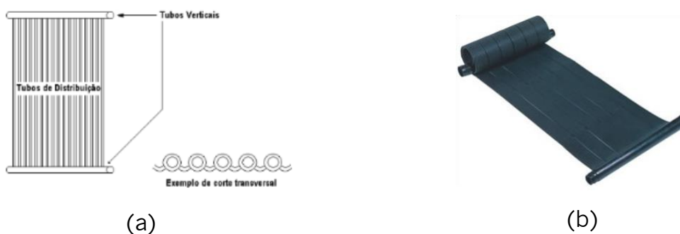
Figura 2.13 - Coletor plano sem cobertura (a) esquema (b) exemplo [8]
