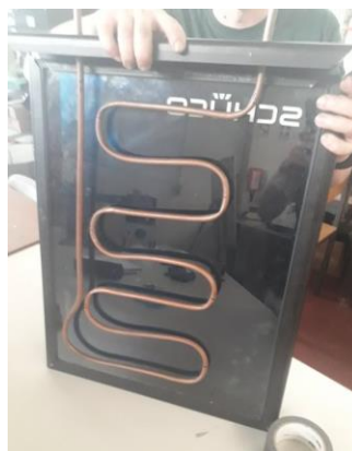
Figura 4.7 - Montagem do coletor solar Schuco
