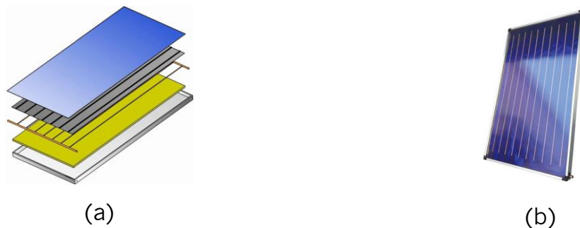
Figura 2.14 - Coletor solar plano (a) esquema (b) exemplo [10]
