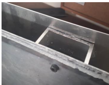
Figura 4.6 - Ligação feita para unir a chapa absorvedora à chapa traseira
