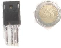
Figura 5.16 Semicondutor SiC MOSFET *C3M0065100K* utilizado no conversor CA-CC PFC e no inversor *full-bridge*.
