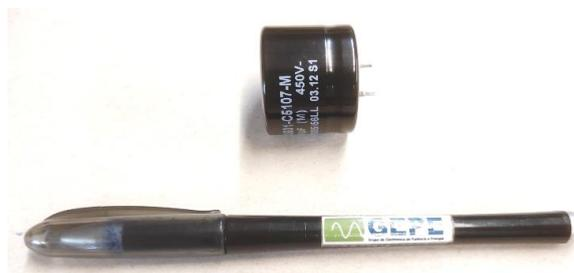
Figura 5.18 Condensador eletrolítico utilizado no barramento CC.
