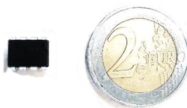
Figura 5.7 Sensor de tensão *Si8920*.
