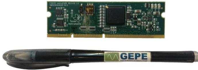
Figura 5.5 Placa de desenvolvimento DSP *TMDSCNCD28335*.
