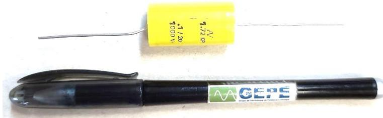
Figura 5.19 Condensador de desacoplamento utilizados nos braços dos conversores.
