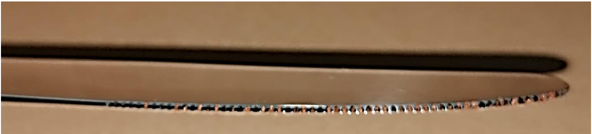
Figura 19-Faca oxidada na serrilha
