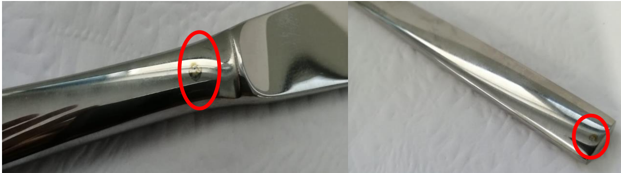
Figura 18-Faca com indícios de oxidação no cabo
