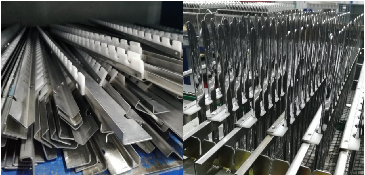
Figura 15-Aplicação de proteção de plástico nas queilhas
