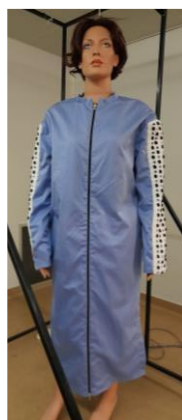
Figura 76 - Manequim térmico vestido com a peça que se vai avaliar
