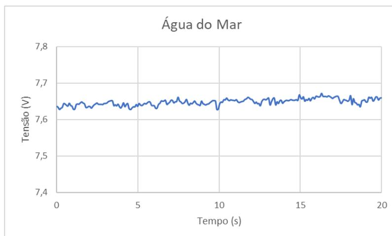
**Figura 57.** Valores de tensão registados com a passagem de água do mar pela plataforma microfluidica.
