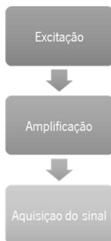
**Figura 49.** Representação esquemática dos principais módulos eletrônicos necessários para as medições em AC.
