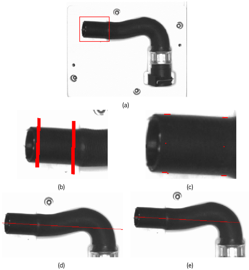
Figura 4.10: Passos para medição da distância 3: (a) região de trabalho; (b) regiões definidas pelo utilizador; (c) extração dos pontos médios das regiões de (a); (d) segmento de reta obtido com os pontos de (c); (e) interseção de (d) com a região do tubo.
