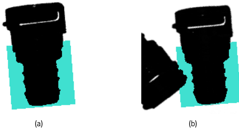
Figura 3.13: Verificação da violação da área de picking: (a) não violada; (b) com obstruções.
