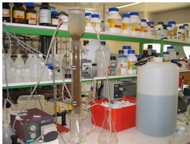
Figura 4.2 – Fotografia da instalação de remoção de cromo (III) em sistema aberto.
