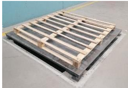
Figura 40 – Evidências fotográficas da não existência de uma rampa de acesso numa balança
