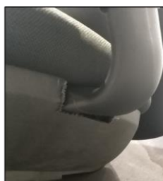
Defeito em externo do assento (falha de acabamento) Detetado na embalagem, falta de inspeção na montagem.
