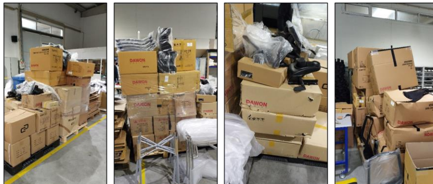
Excesso de carga / Altura elevada da carga / Falta de identificação dos componentes / Excesso de peças soltas
