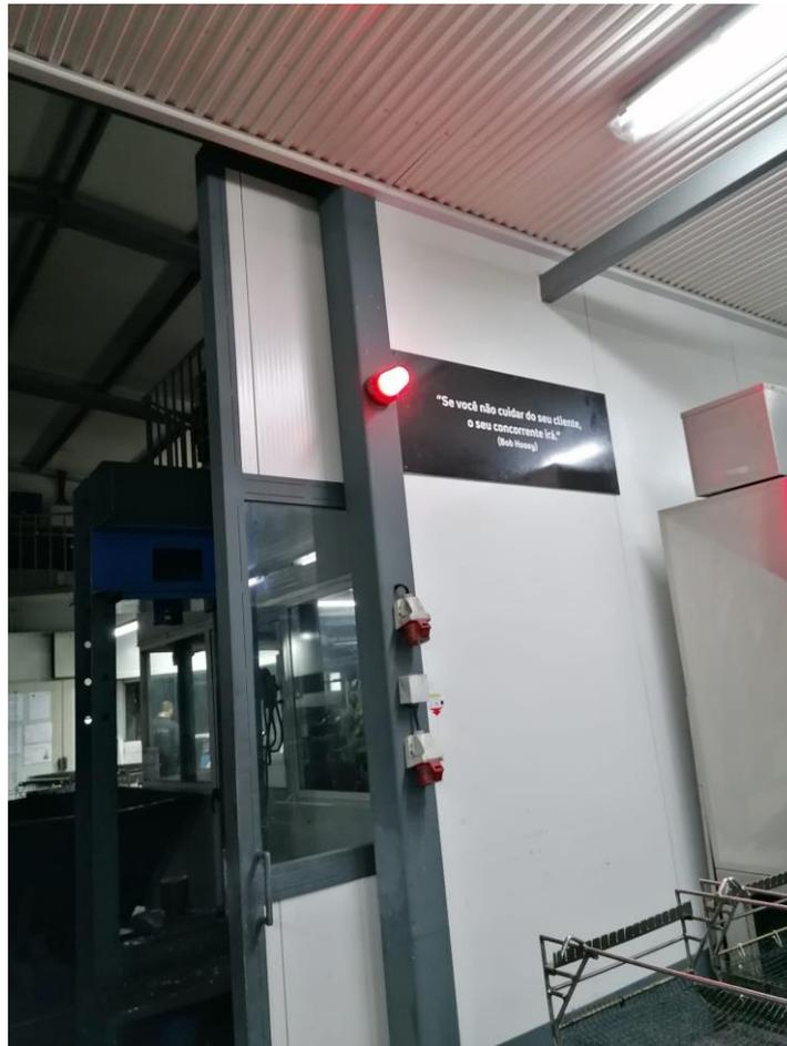
*Figura 33 - Sistema de sinal luminoso na secção de embalagem*
