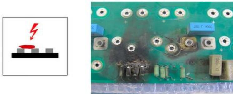
Figura 4 - Exemplo de um curto-circuito num PCB (Fonte *Zestron*)
