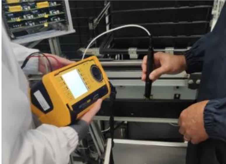
Figura 67 - Exemplo da verificação ESD a uma correia de distribuição
