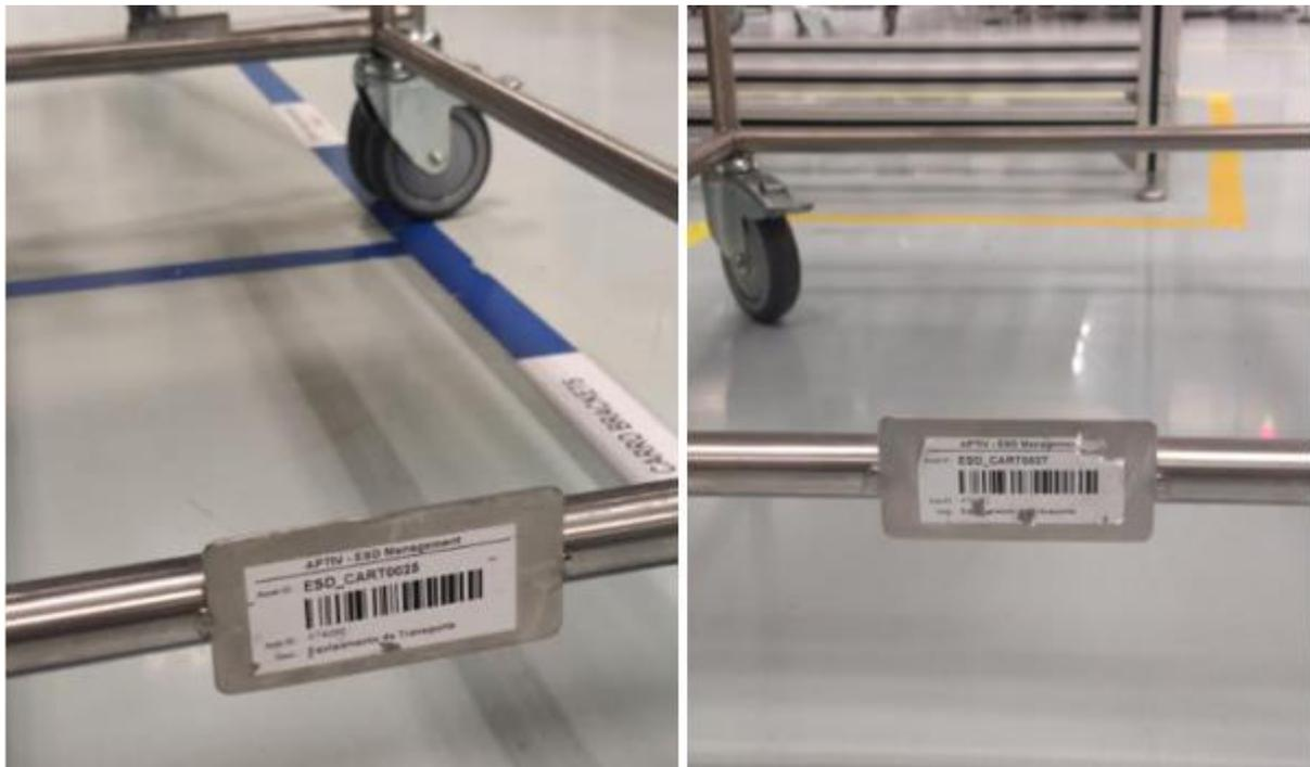
Figura 90 - Desgaste/ danificação das etiquetas ESD
