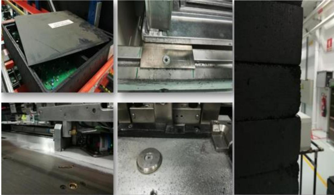
Figura 54 – Partículas visíveis em equipamentos de contacto direto com os dispositivos
