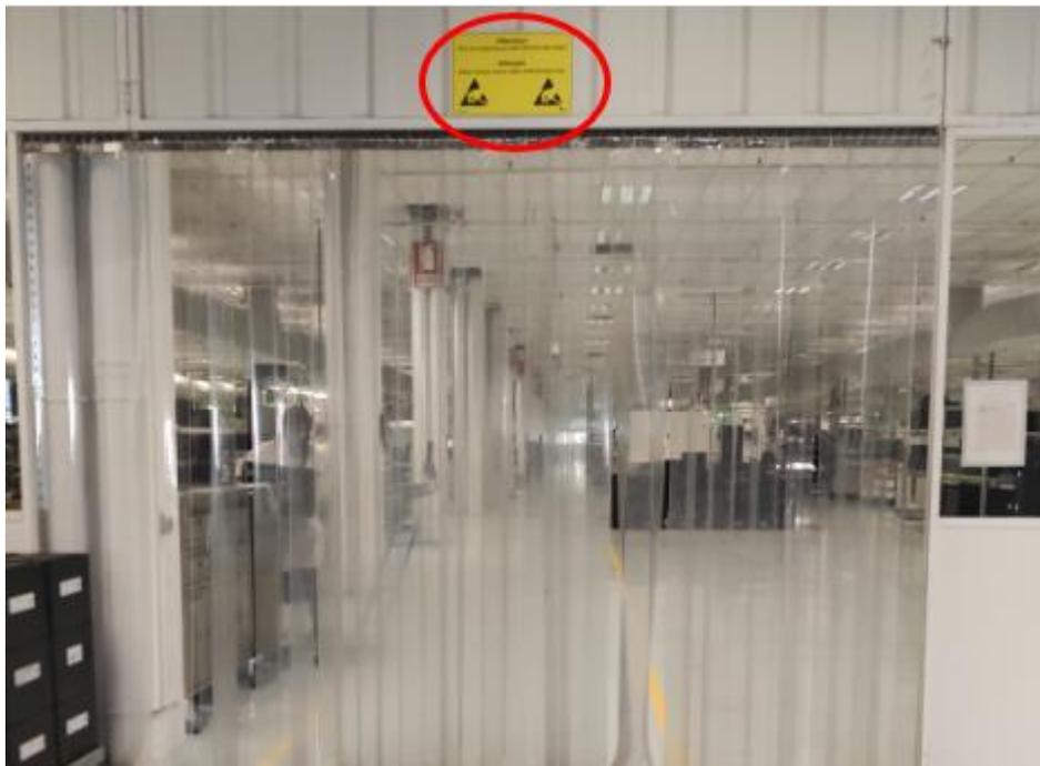
Figura 61 - Exemplo de símbolos de identificação à entrada de uma EPA na APTIV
