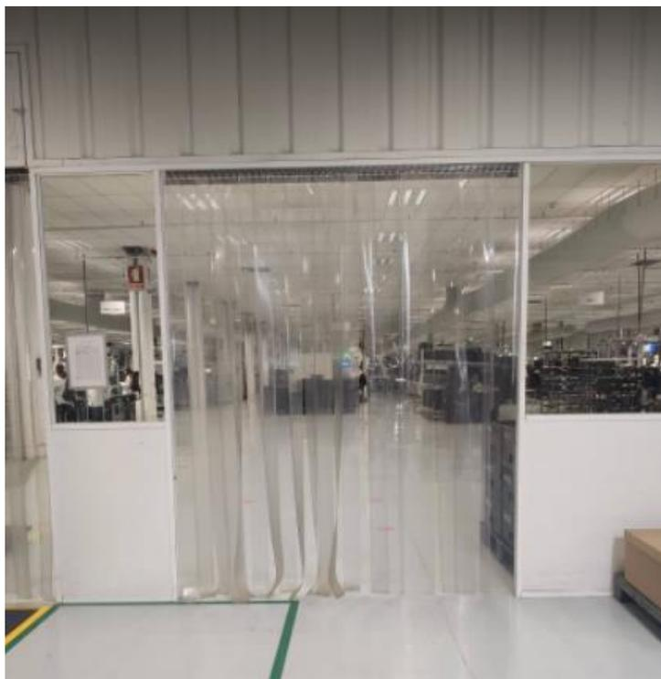
Figura 85 - Entrada para uma EPA sem identificação
