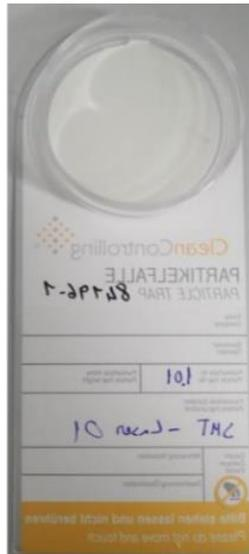
Figura 40- Exemplo de uma *Particle Trap*
