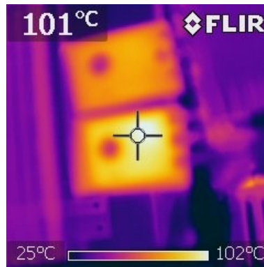
Figura 7.1 – Temperatura média alcançada pelos reguladores de tensão presentes na PCB: LM7805 na parte inferior e LM1117 na parte superior.
