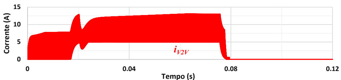
Figura 4.19 - Forma de onda da corrente i_{V2V} presente no barramento CC do conversor CC-CC bidirecional buck boost split pi em modo II.
