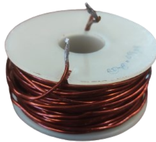
Figura 5.22 – Bobina de núcleo de ar utilizada no conversor CC-CC bidirecional não isolado buck boost split pi .
