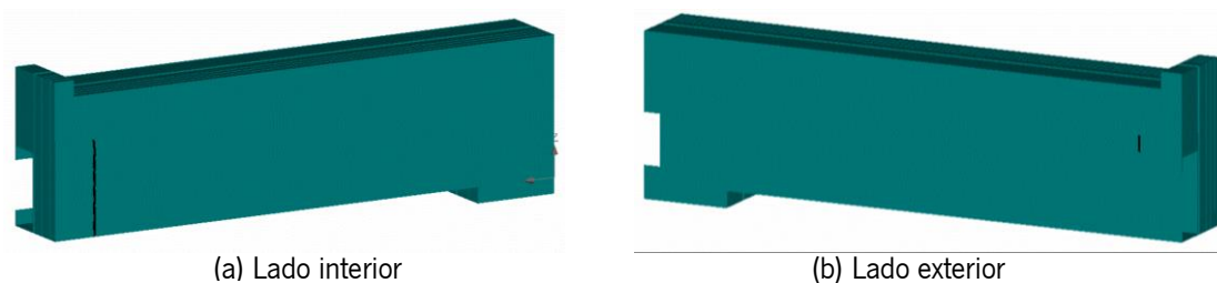
Figura 6.27 – Modelo 2A: Início de fendilhação ( P = 11,6 kN). Largura de fenda \geq 0,03 mm.
