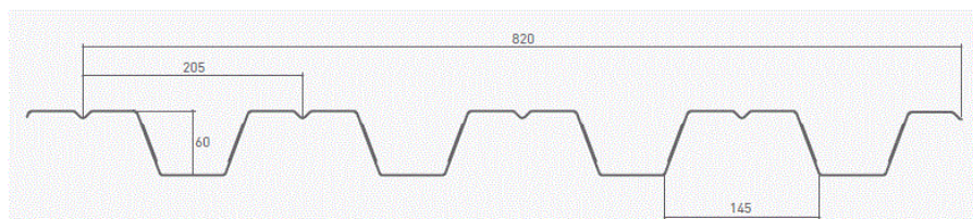
Figura 3.15 – Dimensões da chapa colaborante H60.
