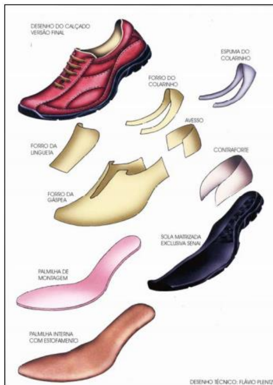
Figura 5: Peças que compõem o calçado. (Fonte: Centro Tecnológico do Calçado, 2007).
