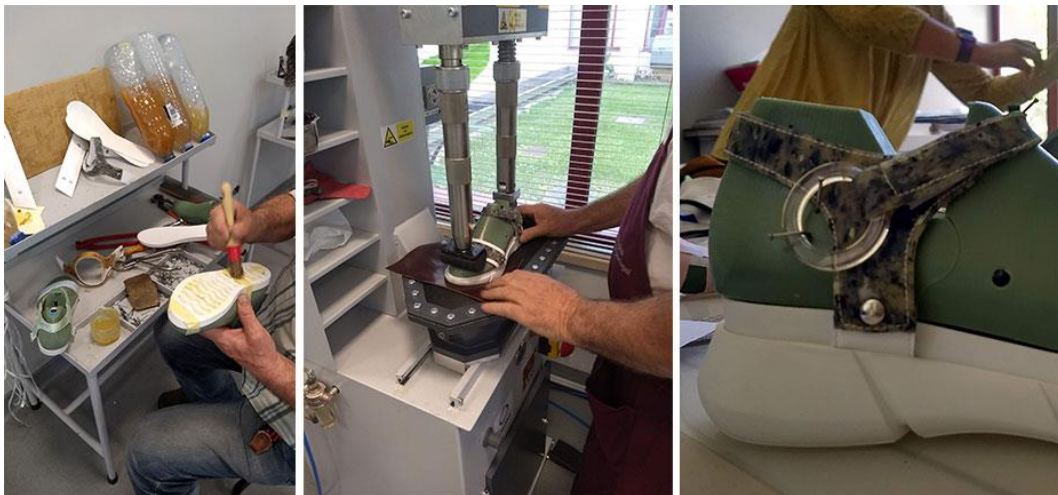
Figura 69: Colagem e fixação da sola à parte superior do calçado.
