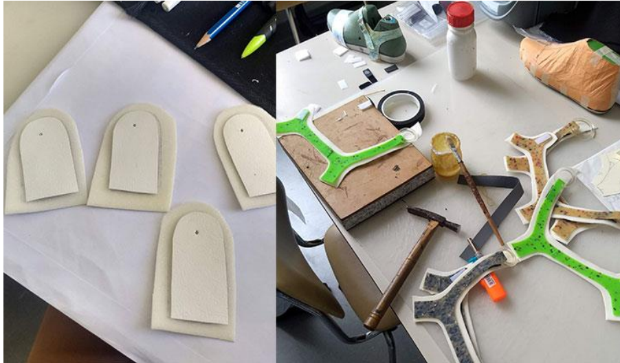
Figura 66: Colagem das diferentes peças ao forro.
