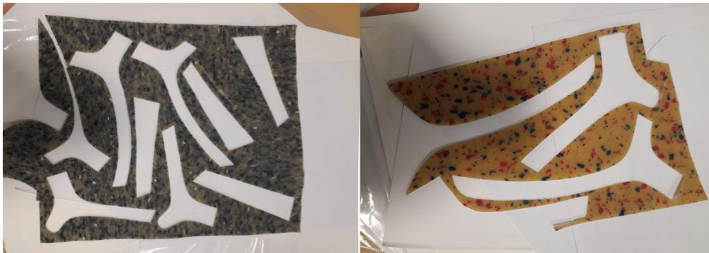
Figura 65: Posicionamento dos moldes nos materiais para corte dos diferentes componentes do calçado.
