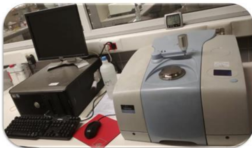
Figura 8 - Imagem do equipamento de Espetroscopia de Infravermelho com Transformada de Fourier por Refletância Total Atenuada - FTIR-ATR – utilizado (Perkin Elmer Spectrum 100).
