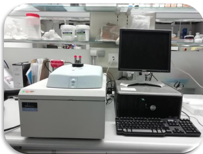
Figura 10 - Imagem do equipamento utilizado para análise calorimétrica de varrimento (Pyris Diamond da Perkin Elmer com um Intracooler ILP).
