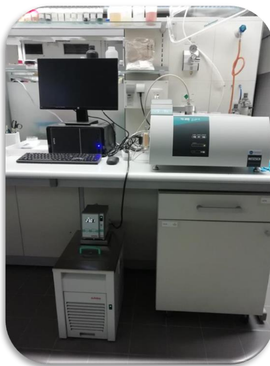
Figura 9 - Imagem do equipamento utilizado em análises de termogravimetria (TGA 209 F1 Libra da Netzsch).
