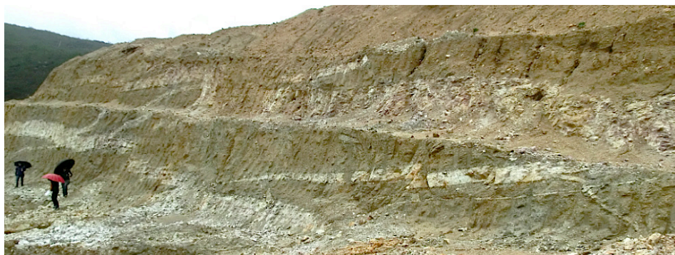
Figura 13 – Mina de Alvarrões – Cabanas, Região da Guarda – exploração de mistura felspática alitinada, em aplito –pegmatito LCT lepidolítico. Representa o ciclo extrativo cerâmico atual.
