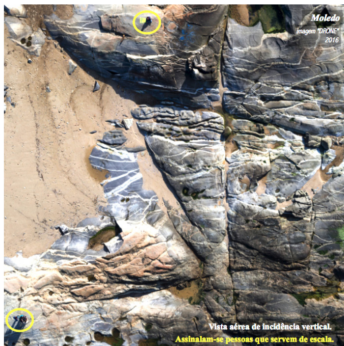
Figura 12 – Vista aérea sobre o afloramento de parte de um enxame filoniano mineralizado com Li (espodumena primária, amblygonite, turmalina, lepidolite) que dada a sua localização na Praia de Moledo e dada a tipologia de ordenamento atribuída ao local, dificilmente virá a ser objeto de qualquer intervenção extrativa.
