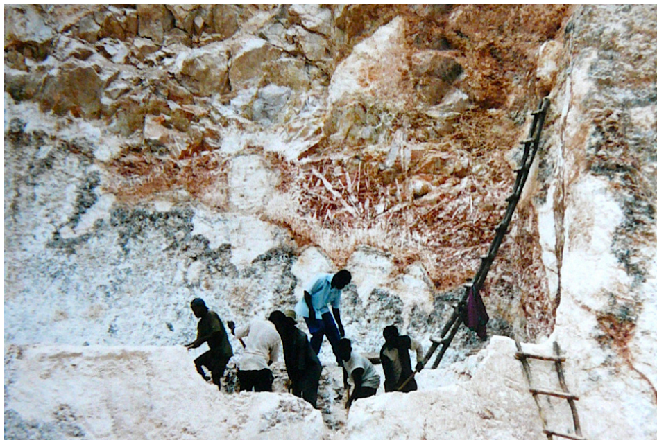
Figura 3 - Concentração de espodumena (cristais prismáticos alongados brancos) na zona intermédia interna, a muro, no corpo principal do grupo pegmatítico de Naipa, Província Pegmatítica da Zambézia, N de Moçambique.
