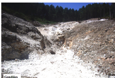
Figura 15 – Minas de Trás-os-Montes em Alijó e Gondiaes – exploração de mistura feldspática alitínada, em aplito – pegmatitos LCT petalítico-espoduménicos. Representa o ciclo extrativo cerâmico atual.
