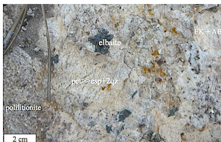
Figura 16 – Mina do Beça (corte principal) – Trás-os-Montes – exploração de cassiterite em pegmatito LCT petalítico-espoduménico. Representa o ciclo extrativo do Sn na primeira metade do século XX.
