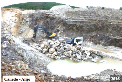
Figura 15 – Minas de Trás-os-Montes em Alijó e Gondiaes – exploração de mistura feldspática alitínada, em aplito – pegmatitos LCT petalítico-espoduménicos. Representa o ciclo extrativo cerâmico atual.
