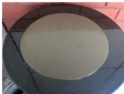
Figura 5 - Argamassa após o teste de espalhamento.
