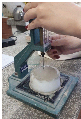
Figura 4 - Ensaio da agulha de Vicat.
