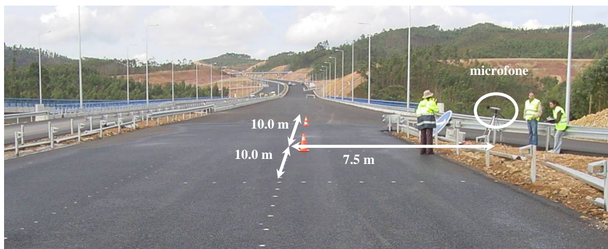
Figura 1 – Esquema de localização dos microfones
