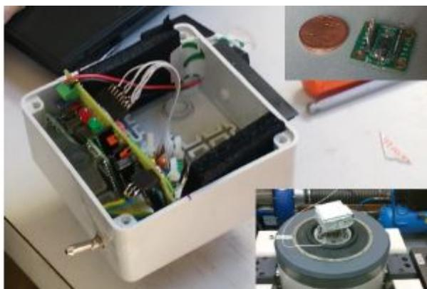
**Figura 2.3:** Protótipo do nó sensor.
