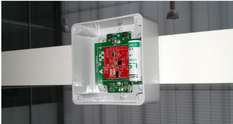
**Figura 2.9:** Nó ED instalado na caixa de proteção.
