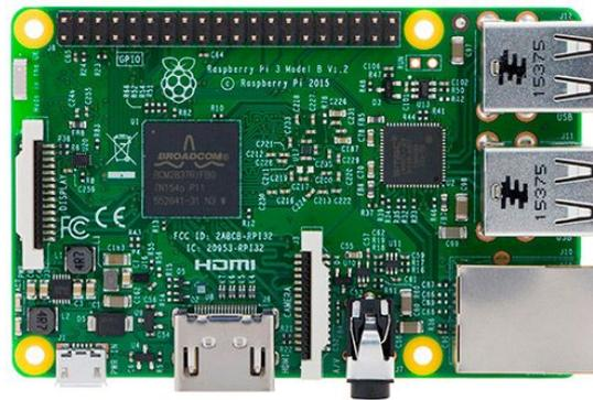
**Figura 3.6:** Placa de desenvolvimento RaspBerry Pi 3 *model/B*.
