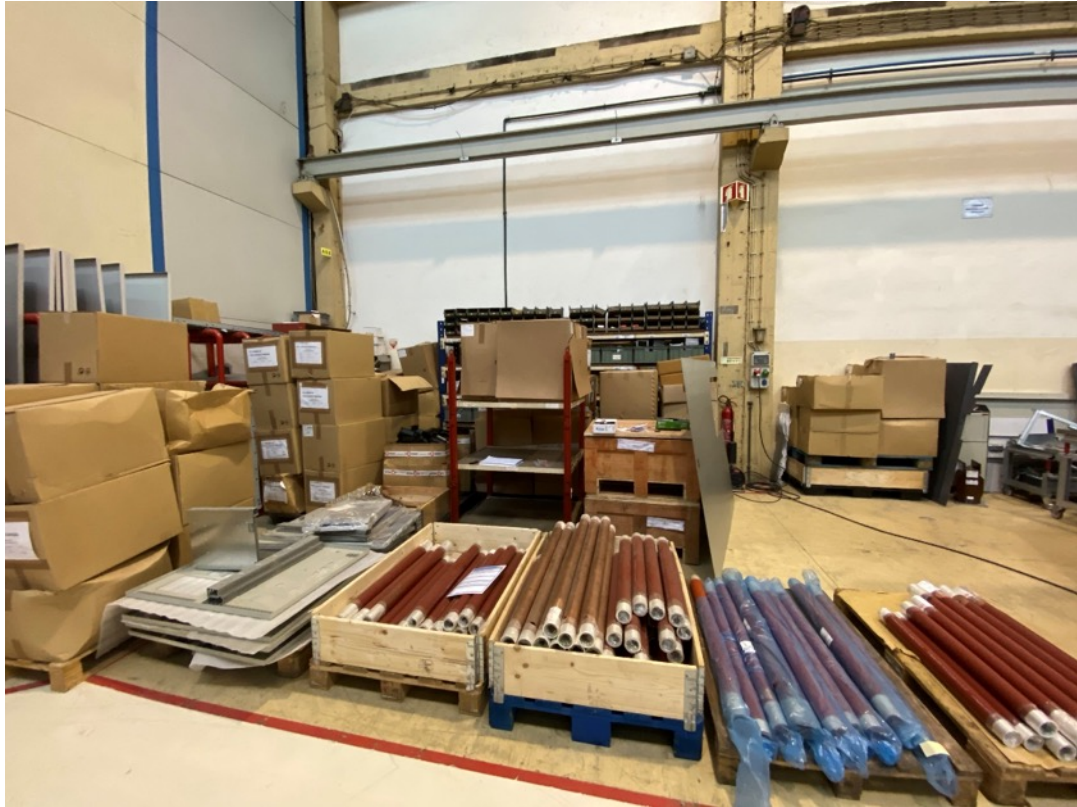
Figura 90 – Local de montagem e de picking obstruído por material não identificado
