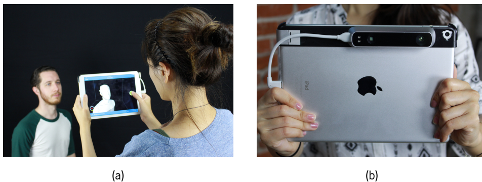
Figura 2.10: Sistemas Structure Sensor: a) Aplicação iPad 10 b) Aplicado num iPad 11 .
