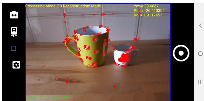
Figura 6.18: Deteção de pontos de interesse através do algoritmo ORB na aplicação Android.
