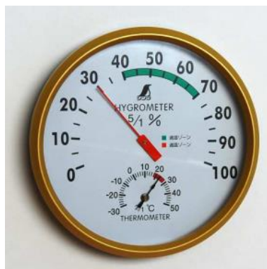
Figura 3-3. Higrômetro mecânico. (Fonte: FineTools 11 )
