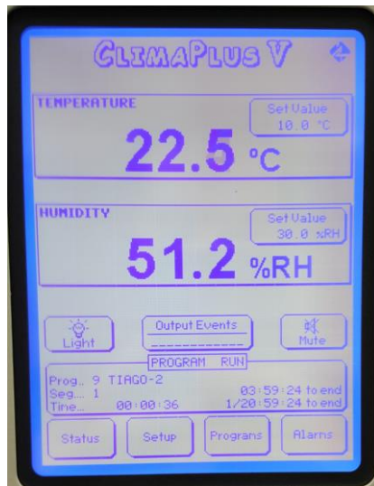
Figura 5-1. Interface e monitor sensível a toque da câmara de ambiente controlado.
