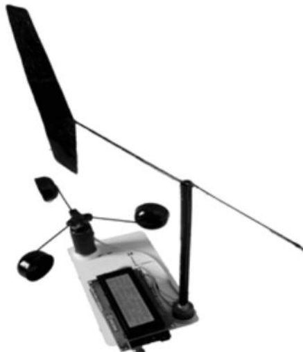
Figura 2-2. Artefacto eletrónico de recolha de dados ambientais baseado em Arduino proposto pelos autores em (Saini et al. , 2016).
