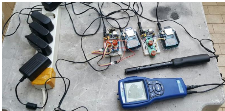
Figura 5-13. Dispositivos durante execução ao ar livre. À esquerda as fontes de alimentação; ao centro, os artefactos eletrónicos; na parte inferior central, o instrumento de referência da marca TSI.
