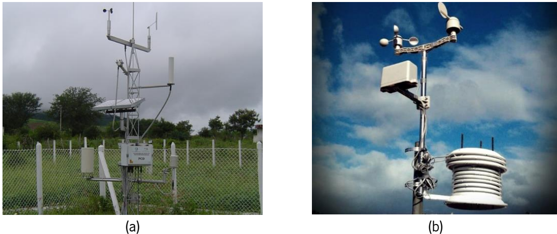
Figura 2-1. Plataformas automatizadas de recolha de dados ambientais. (a) Brasil (INPE); (b) Portugal (IPMA).
