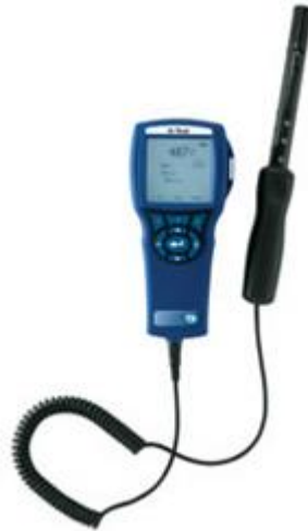
Figura 4-21. Equipamento utilizado como referência para o monóxido de carbono.
