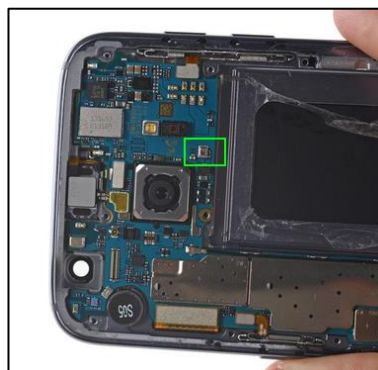
Figura 3-9. Barômetro (em destaque verde) na placa mãe do smartphone Samsung Galaxy S7. 15
