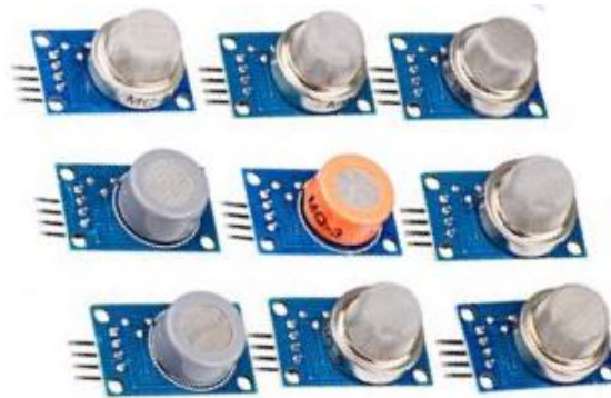
Figura 3-14. Conjunto de sensores de gases a óxido metálico em placas de interface analógica. (Fonte: Emakefun 21 )
