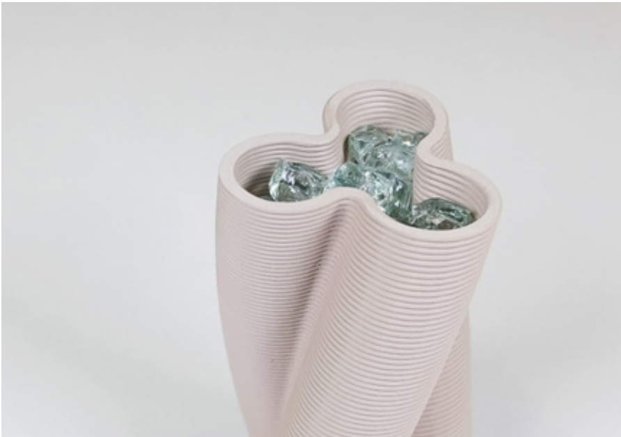
Fabrico aditivo em cerâmica. Incorporação de vidro temperado em componentes arquitetônicos cerâmicos, 2019 João Carvalho
