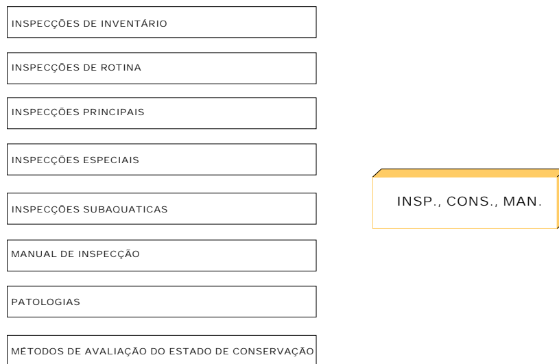
Figura 11.9 - Inspeção, conservação e manutenção de pontes
