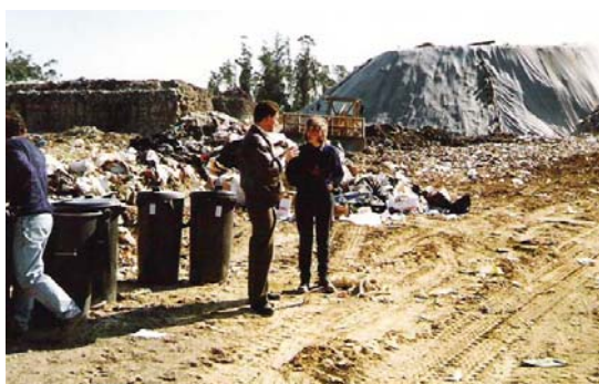
Controlo da amostragem no aterro, enchimento dos contentores de volume conhecido
