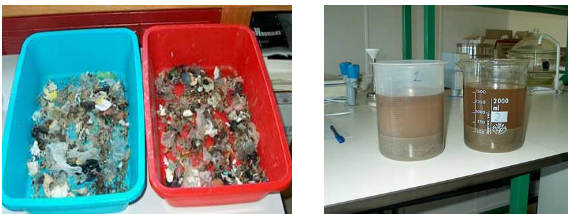
Figura 6.6 – Fracção inerte não atacada pelo hipoclorito e fracção fina (areias) em decantação.
