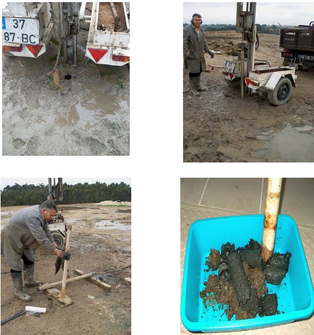
Figura 6.4 - Procedimentos de amostragem em campanha de Inverno e amostra no laboratório
