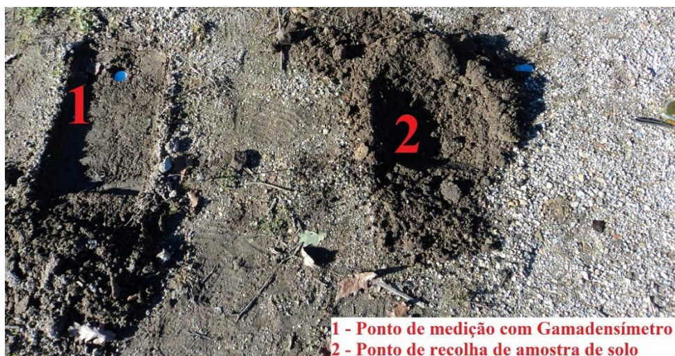
Figura 33 - Recolha de amostra de solo para determinar o teor em água pelo Método da Estufa
