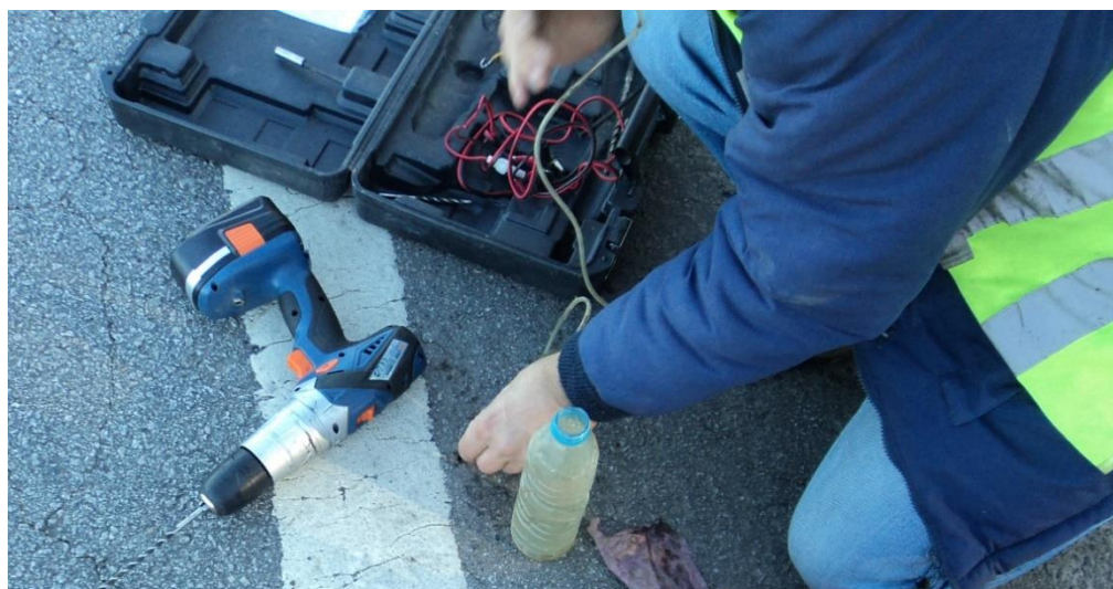
Figura 35 - Introdução de glicerina em orifício para medição da temperatura a 4,5 cm de profundidade
