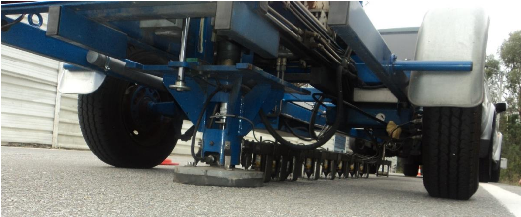
Figura 9 - Vista dos geofones do Defletómetro de Impacto
