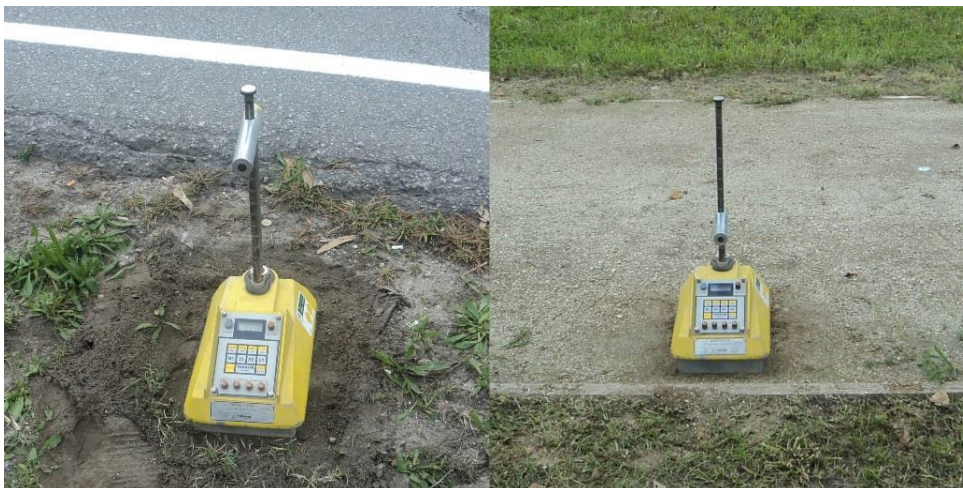
Figura 30 - Realização de ensaio com Gamadensímetro: Método de transmissão indireta à esquerda e Método de transmissão direta à direita
