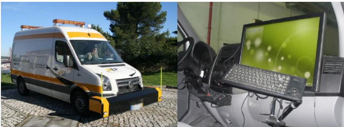
Figura 6 - Perfilómetro Laser utilizado para inspeção mecânica de pavimentos: Viatura com barra de sensores laser (esquerda) e equipamento do operador (direita) (Horta et al. , 2013)
