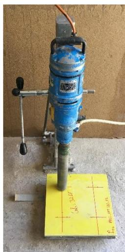
Figura 3.22 – Caroteador utilizado para perfuração dos provetes.
