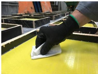
Figura 3.19 – Preparação da superfície de GFRP para receber o adesivo.
