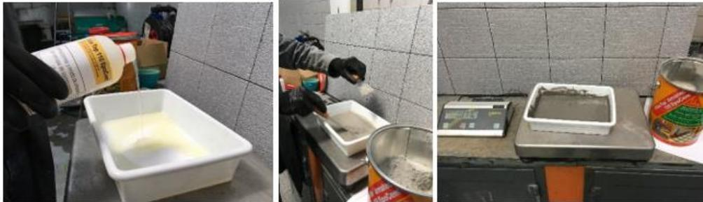
Figura 3.15 – Preparação do SikaTop Armatex – 110 EpoCem – Sika.
