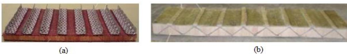
Figura 2.5 – Painéis desenvolvidos por Norton (2004): (a) painel tipo 2 sem treliça no núcleo e com conectores metálicos e (b) painel tipo 3 com treliça no núcleo e com conectores compósitos.
