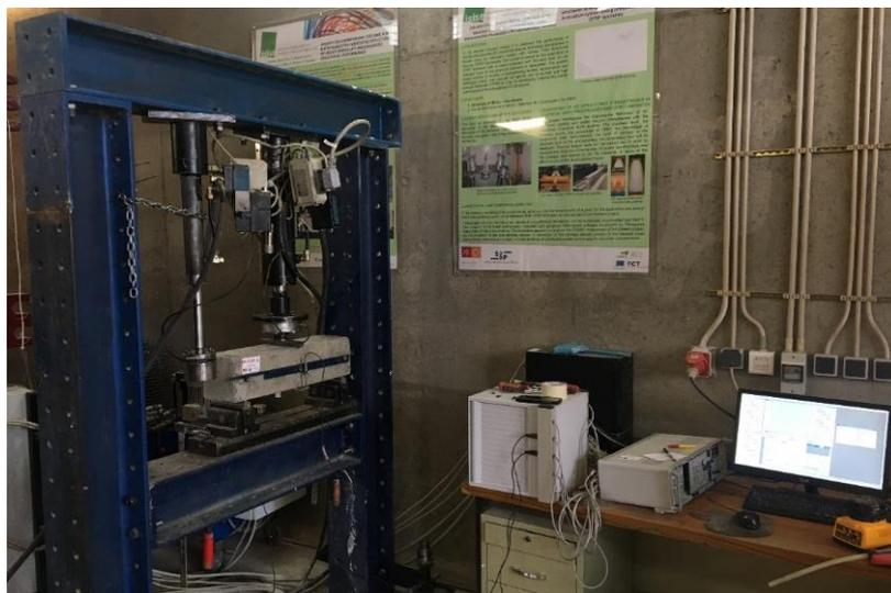
Figura 3.32 – Equipamento e sistema de reação utilizado nos ensaios de flexão.
