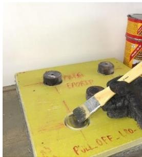
Figura 3.23 – Aplicação de adesivo para colagem dos discos
