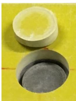
Figura 3.27 – Modo de rotura identificado antes do início do ensaio: não aderência entre GFRP/SCSFRMC (ligação descolada).
