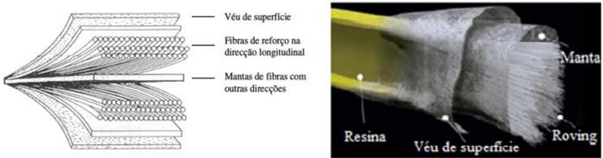
Figura 2.17 – Representações da disposição típica das camadas num compósito pultrudido (adaptado de (Correia, 2013)).
