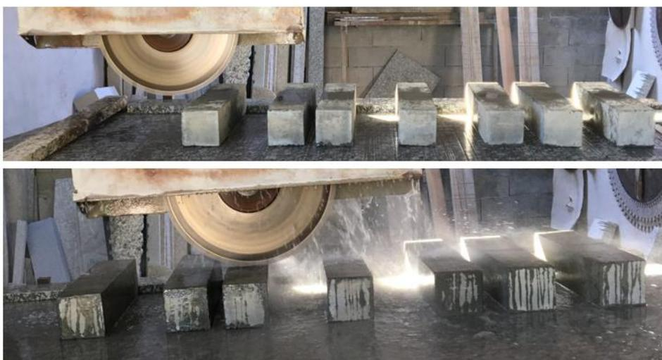
Figura 3.33 – Abertura de entalhes em provetes prismáticos.
