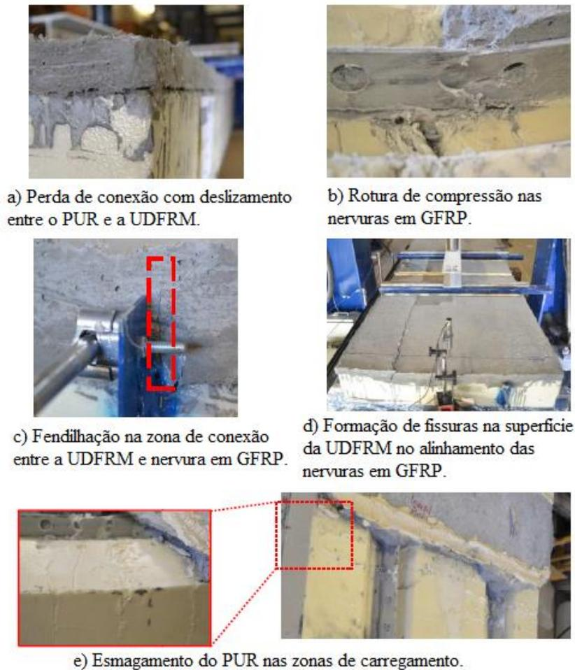
Figura 2.12 – Danos sucessivos observados durante o ensaio do painel sanduíche híbrido (adaptado de (Mastali *et al.*, 2015)).
