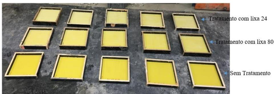
Figura 3.14 – Preparação das cofragens e colocação do GFRP para aplicação dos diferentes adesivos e posterior betonagem do SCSFRMC.
