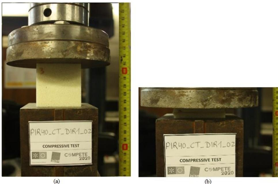
Figura 5.3 – Configuração do ensaio de compressão em PIR: (a) fase pré-inicial do ensaio e (b) fase final do ensaio.
