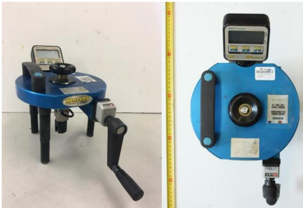
Figura 3.6 – Equipamento E142 da Matest, utilizado nos ensaios de tipo “pull-off”.
