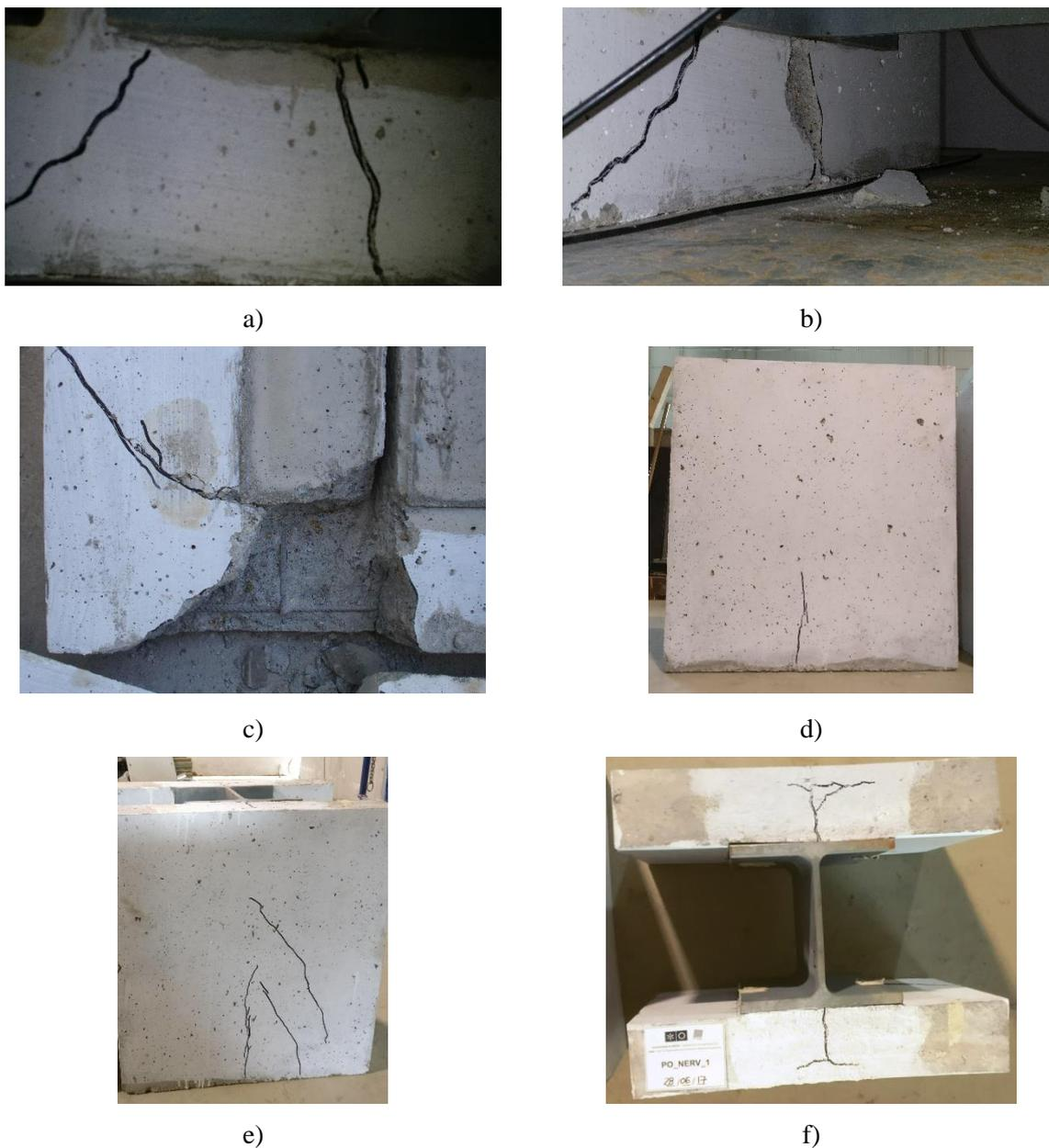
Figura 4.8 - Evolução da fendilhação no provete PO\_NERV\_1
