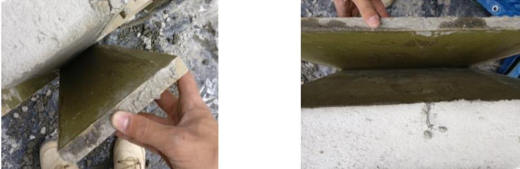
Figura 3.19 - Descofragem dos provetes de tipo *push-out*
