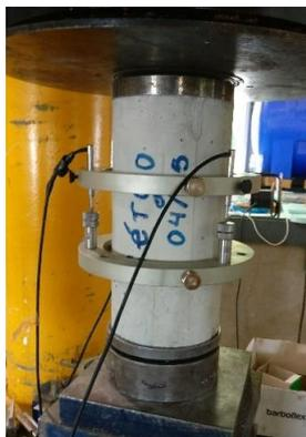
Figura 3.26 - Pórtico de ensaio e monitorização para o ensaio de módulo de elasticidade
