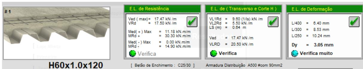
Figura 6.4 - Verificações de segurança em lajes mistas realizadas com o *software* H60 Calculator
