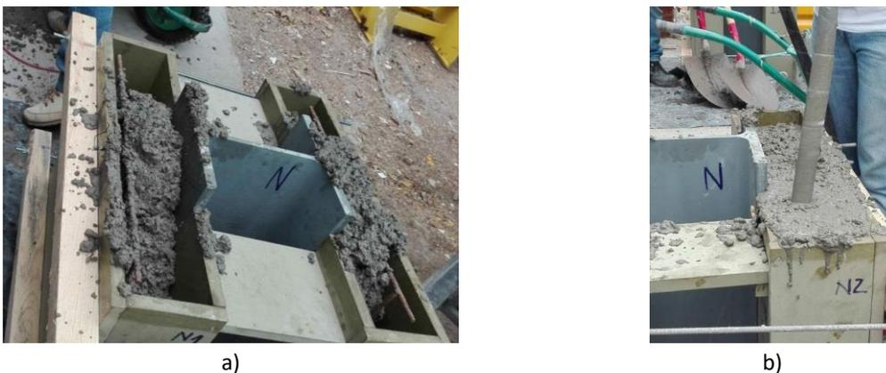
Figura 3.15 - Provede de tipo *push-out*: a) Enchimento; b) Compactação
