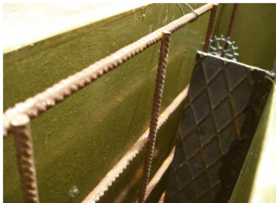
Figura 3.6 - Armadura disposta no interior do provete
