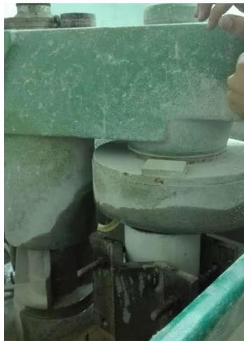
Figura 3.22 - Retificação dos provetes cilíndricos
