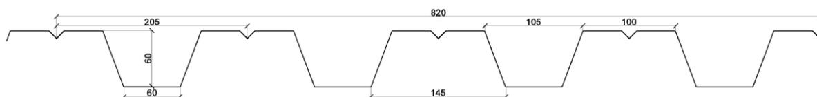
Figura 3.9 - Geometria do perfil H60 [mm], Adaptado (OFELIZ, 2016)
