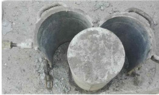
Figura 3.21 - Desmoldagem dos provetes cilíndricos
