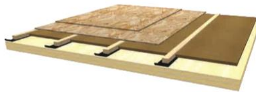
Fig. 13 – Pavimento em CLT com isolamento acústico aplicado no topo (Karacabeyli e Douglas, 2013).
