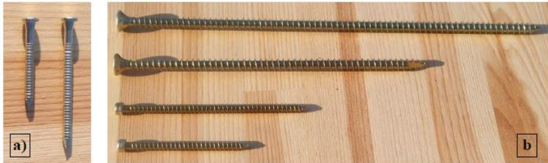
Fig. 26 – a) pregos de aro anelar; b) parafusos auto-perfurantes totalmente roscados (Piazza et al. , 2013)
