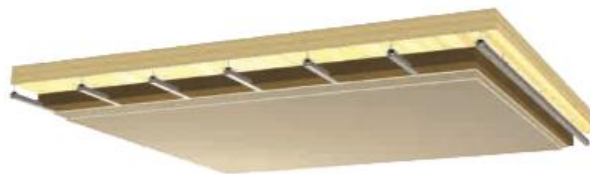
Fig. 13 – Pavimento em CLT com isolamento acústico aplicado no topo (Karacabeyli e Douglas, 2013).
