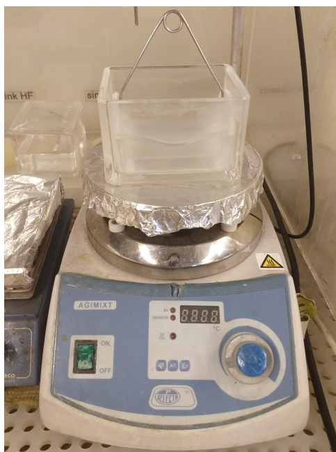
Figura 4.7: Placa de aquecimento e agitação magnética Agimixt da JP Selecta usada na revelação do polímero fotossensível.
