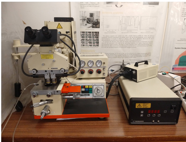
Figura 4.6: Equipamento Karl Suss MJB3 usado na exposição do polímero fotossensível.
