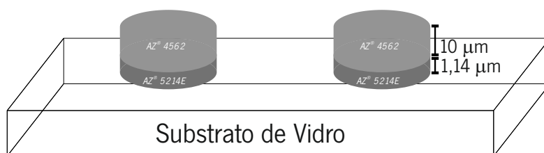
Figura 4.9: Estruturas cilíndricas obtidas no fim do processo fotolitográfico com os polímeros AZ ® 4562 e AZ ® 5214E .
