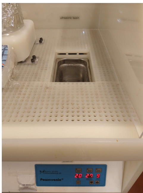
Figura 4.2: Banho ultrassônico usado na remoção de impurezas orgânicas do substrato.
