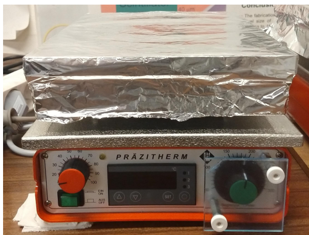
Figura 4.4: Placa de aquecimento Präitherm PZ23-2 da Harry Gestigkeit GmbH usada na cura do polímero fotossensível.
