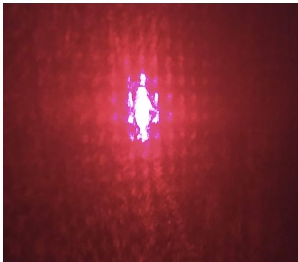
Figura 5.9: Padrões de interferência criados através da incidência de um laser nas microlentes em PDMS, fabricadas a partir dos polímeros fotossensíveis AZ ® 40 XT e AZ ® MIR 701 .
