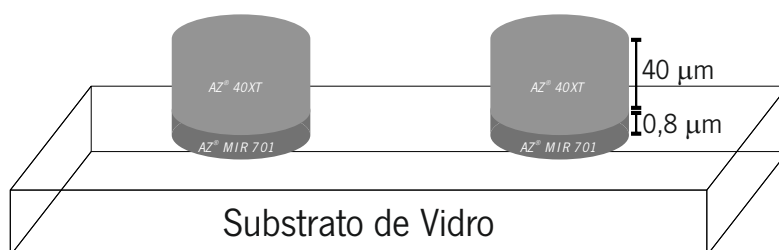
Figura 4.13: Estruturas cilíndricas obtidas no fim do processo fotolitográfico com os polímeros AZ ® 40 XT e AZ ® MIR 701 .
