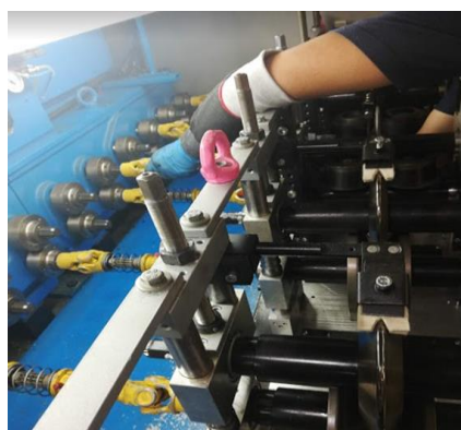
Figura 22 - Operação de retirar e colocar cardans na máquina
