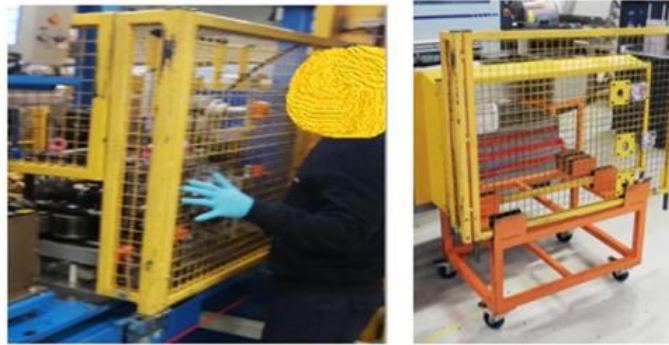
Figura 33 - Momento de retirar grade de proteção
