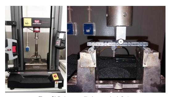
Figura 56. Equipamento utilizado nos ensaios de flexão.
