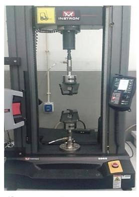
Figura 25. Equipamento utilizado no ensaio de tração
