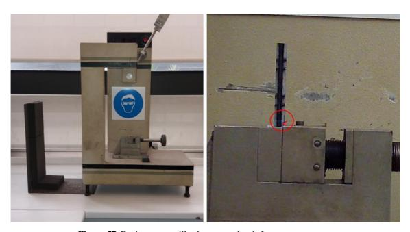
Figura 57. Equipamento utilizado nos ensaios de Impacto.
