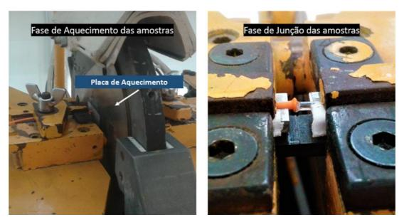
$\textbf{Figura 18.} \ \, \textbf{Ilustração} \ \, \textbf{do processo de soldadura do par PC-Filaflex}.$
