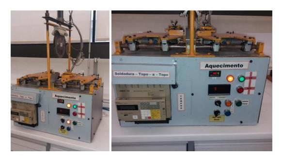
**Figura 14.** Máquina de Soldadura Topo – a – Topo.
