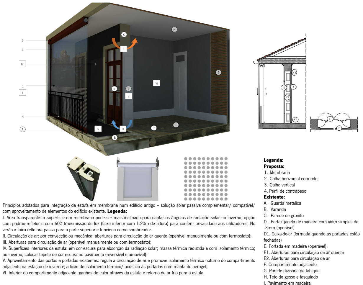
Figura 6.17. Esquemática dos princípios adotados na concepção da solução proposta.
