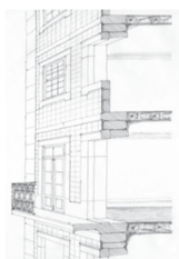
Figura 7.25. Maqueta de uma casa antiga do Porto. Pormenor dos lancis da parede da fachada, da estrutura das paredes de tabique do piso ampliado (integralmente em madeira) e da cobertura. (Teixeira, 2004).
