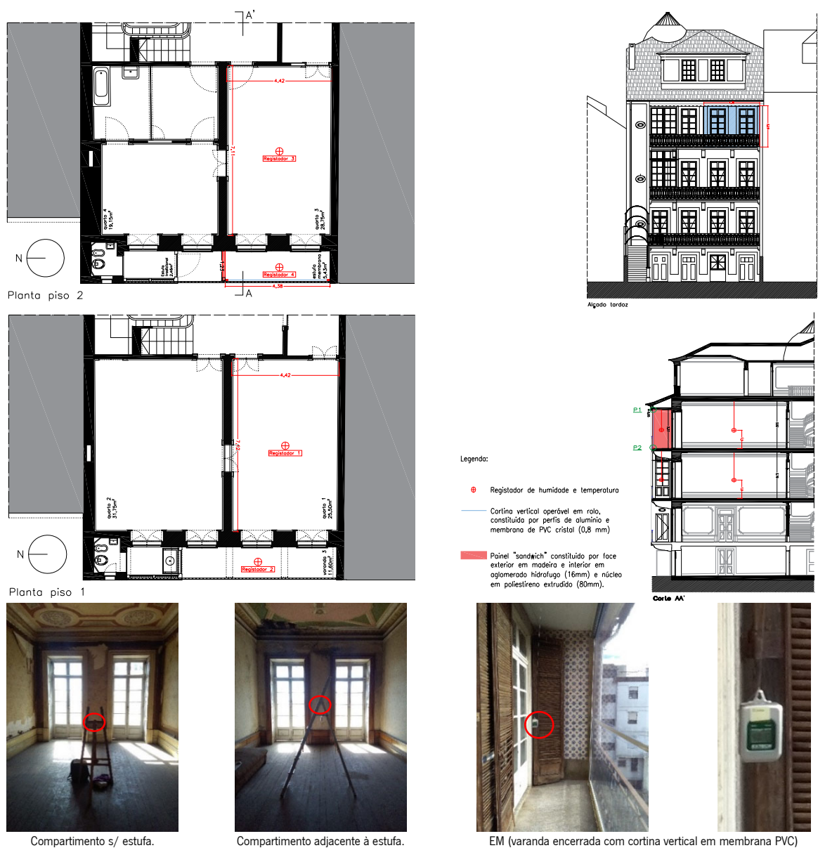
Figura 6.33. Localização dos registadores com sensores de humidade e temperatura do ar.
