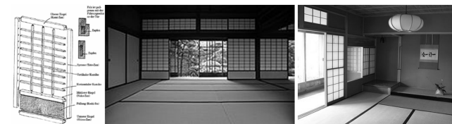
Figura 85: esquema de montagem da shoji e vista interior de um compartimento com paredes shoji (ODATE, 2000).
