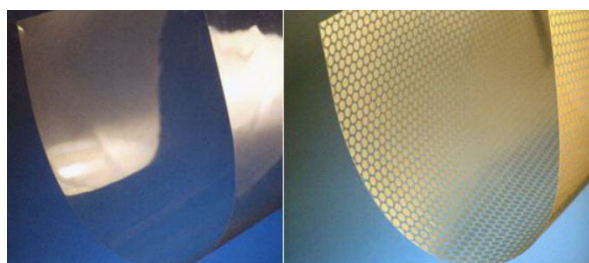
Figura 8.62. Membrana de ETFE transparente (à esquerda) e membrana de ETFE com padrão refletor impresso (à direita) (Koch, 2004).
