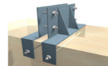
Figura 7.44. Porta-pilar (da esquerda para a direita): em "T" com lâmina interna (Rothblaas, 2018) com ligação superior à viga; duplo – com ligação lateral a viga de madeira.
