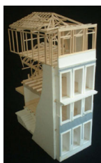
Figura 7.25. Maqueta de uma casa antiga do Porto. Pormenor dos lancis da parede da fachada, da estrutura das paredes de tabique do piso ampliado (integralmente em madeira) e da cobertura. (Teixeira, 2004).
