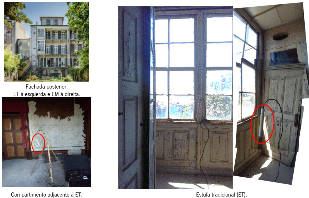
Figura 6.34. Localização dos registadores com sensores de humidade e temperatura do ar na Estufa Tradicional (ET) existente (direita) e no compartimento adjacente (esquerda) na semana de verão.
