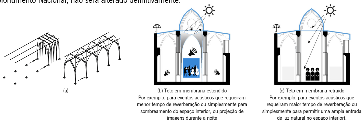
Figura 8.31. Esquema de aplicação do conceito adotado: (a) operação do sistema retrátil; (b) e (c) cenários com a cobertura transparente permanente e teto abobadado translúcido e retrátil.
