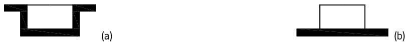
Figura 6.7. Esquemas em planta de estufas: (a) estufa integrada e (b) estufa adossada i (Mendonça, 2005).
