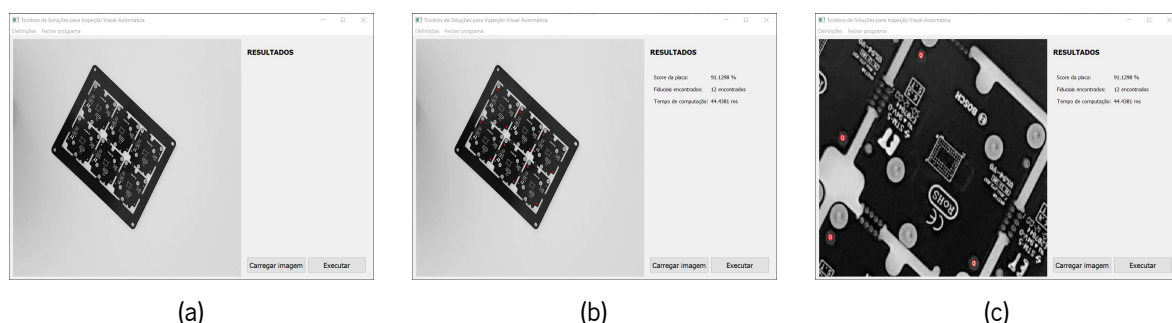
Figura 34: Etapas processadas pela interface do motor de execução: (a) imagem de teste; (b) resultados da execução da solução; (c) zoom in dos resultados através da janela gráfica.
