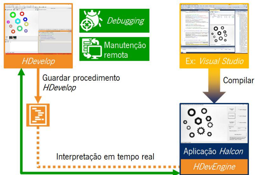
Figura 8: Modo de funcionamento e vantagens do HDevEngine no desenvolvimento de uma aplicação. Adaptado de [31].
