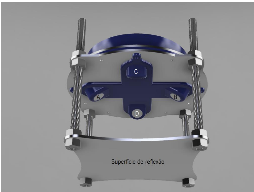
Figura 9 - TOF com superfície de reflexão entre transdutores a duas dimensões.
