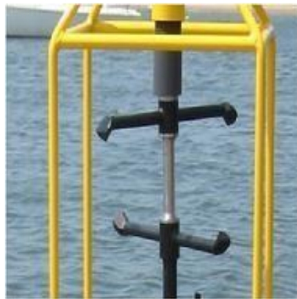
Figura 5 - Sensor de corrente 3D por tempo de voo [9].
