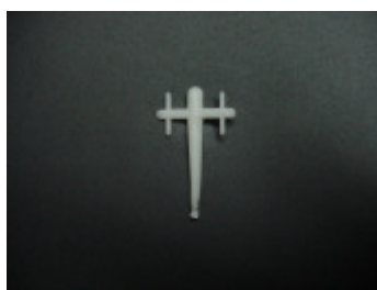
Figura 6.8 – Injecção posterior com insuficiência de material
