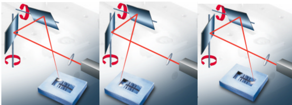
Figura 3.7 – Sequência de movimentos de mesa e de reajuste do feixe laser para a maquinação de paredes verticais [2]
