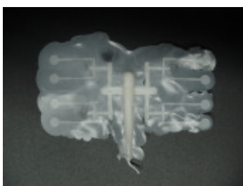
Figura 6.7 – Injecção inicial com excesso de material
