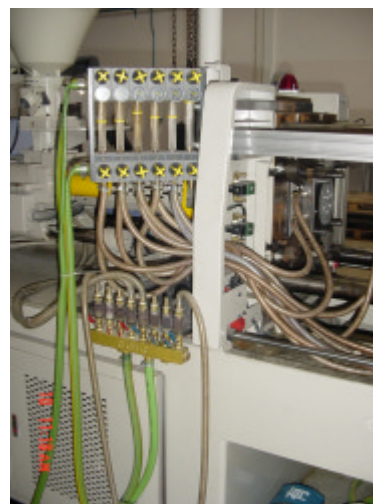
Figura 4.35 – Regulação da Refrigeração da Máquina de Injecção D80.
