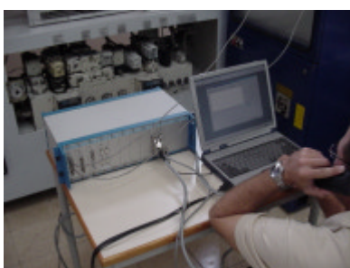
Figura 6.4 – Instrumentação de aquisição de dados de pressão e temperatura Kistler
