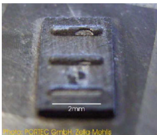
Figura 2.28 – Componente utilizado para os testes de micro-injecção [23]
