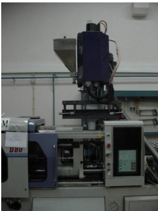
Figura 6.1 – Montagem do molde e unidade de co-injecção na unidade de injecção D80
