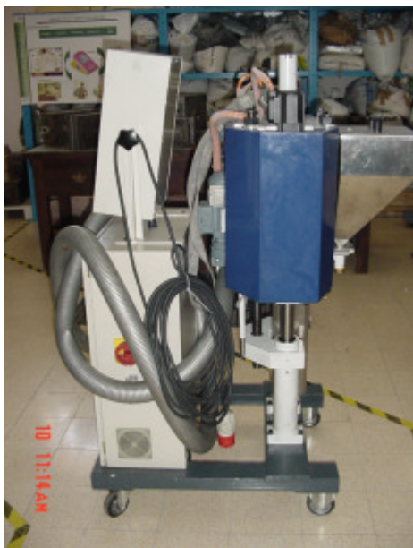
Figura 4.5 – Conjunto Unidade de Controlo e Unidade de CoInjecção Eléctrica Plasdan EL27
