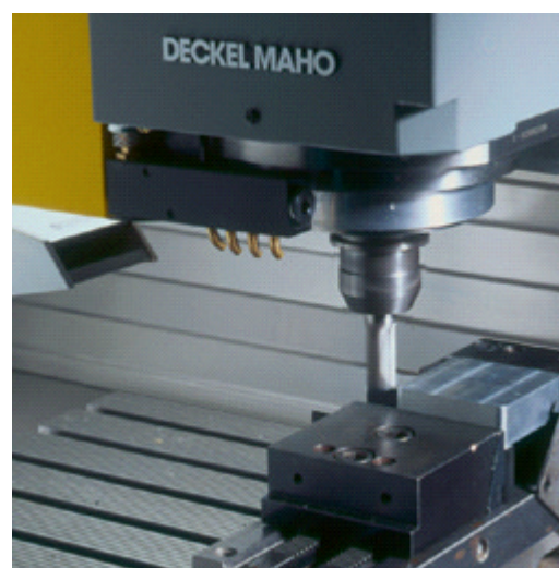
Figura 3.10 – Pormenor do porta-ferramentas da DMU 60L [2]
