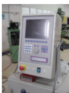
Figura 6.5 – Unidade de controlo da unidade de co-injecção Plasdan EL27
