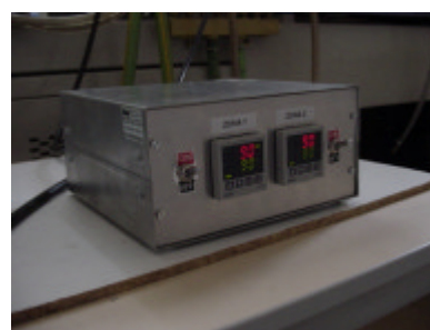
Figura 6.6 – Unidade de controlo de temperatura das resistências do molde
