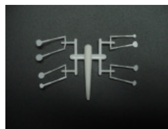
Figura 6.9 – Injecção com insuficiência de material
