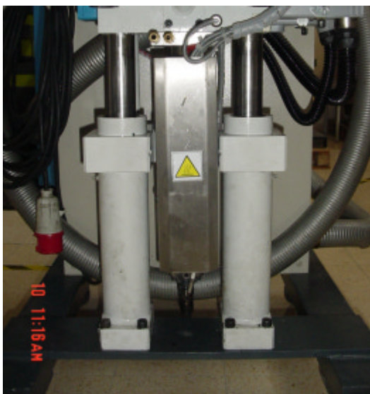
Figura 4.37 – Fotografia do bico de injeção da unidade de co-injecção Plasdan EL27
