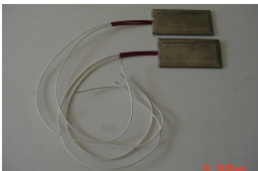
Figura 4.18 – Resistências planas para aplicação por trás da cavidade 1.
