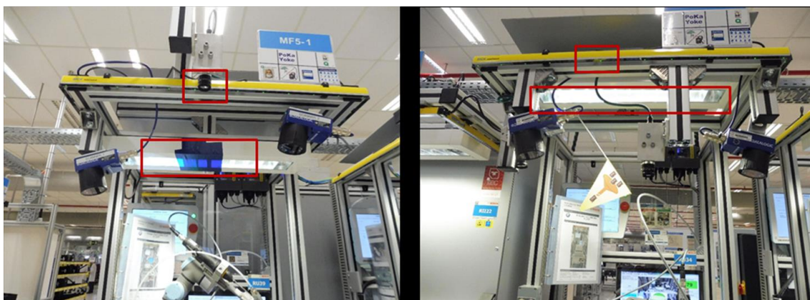
Figura 21 - Exemplos de sistema de inspeção da montagem de foils
