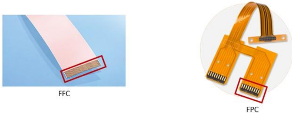
Figura 34 - Foil FFC e FPC (diferença na extremidade)
