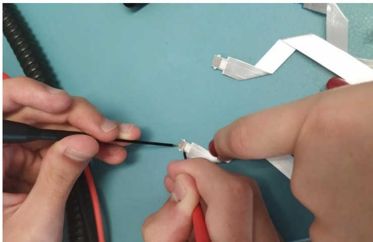
Figura 51 - Medição de condutividade na foil com defeito
