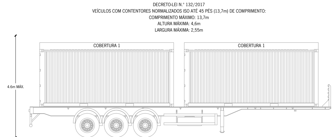
TRANSPORTE DE 2 TIJOLOS HABITACIONAIS "BASE + COBERTURA 1"
