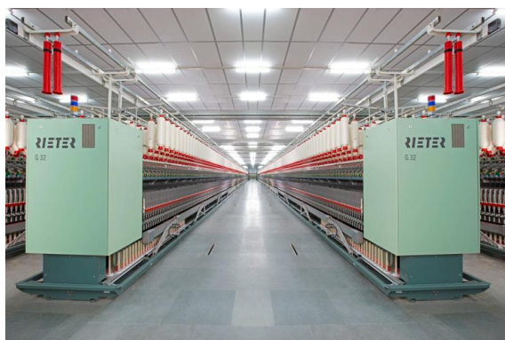
Figura 12 - Continuo de anel a anel Rieter.
