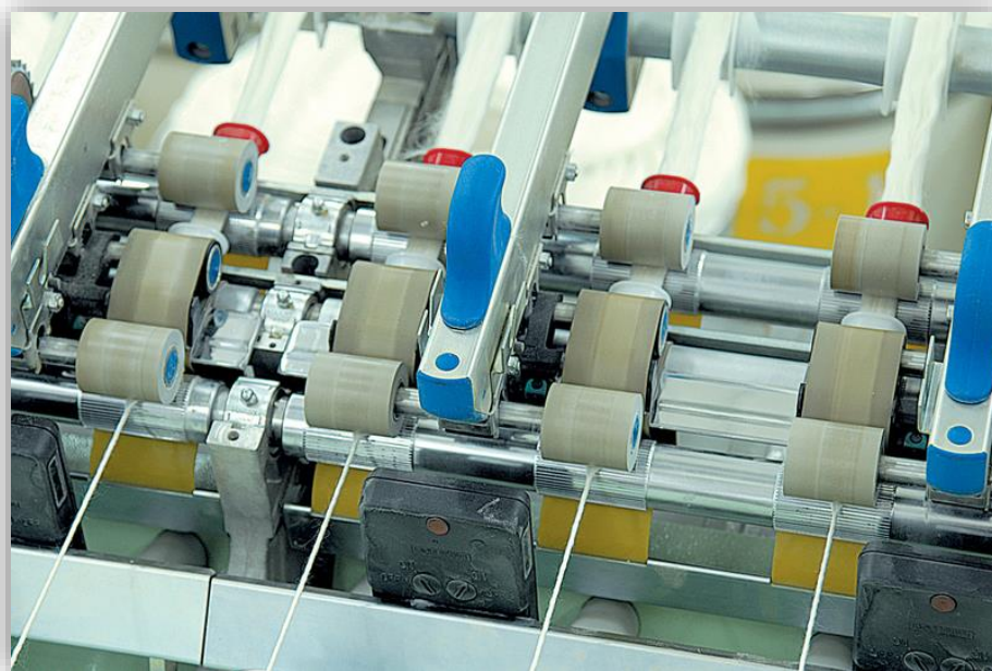
Figura 11 - Sistema de estiragem - torce (Rieter).
