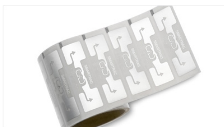
Exemplo de Tag Passiva do tipo Paper Face Tag [30]
