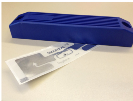
Comparação uma Tag Activa e uma Tag Passiva. [25]
