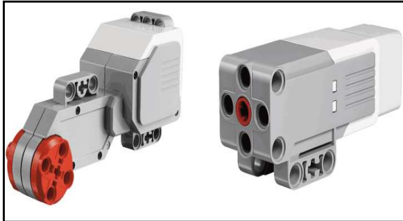
FIGURA 6 - Motor Grande e Motor Médio
