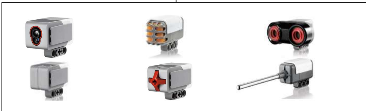
FIGURA 5 - Sensores de cor/luminosidade, som, ultrassônico, giro, toque e temperatura
