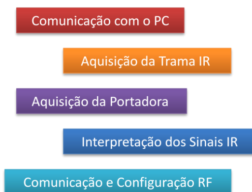
Fig. 61 Blocos constituintes do módulo de aquisição IR
