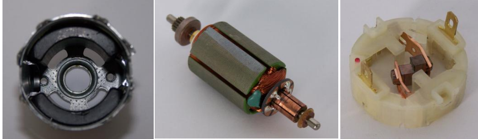
Figura 3-1: Estator (esq); rotor e colectores (centro); escovas (dir)
